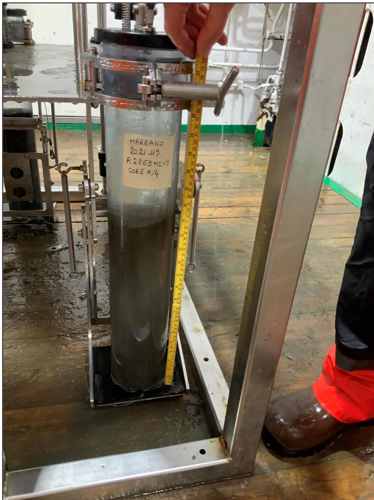
Figur 4. Multicorer-kjerne A fra Stasjon R2869 (Spitsbergenbanken) tatt for uorganiske kjemiske analyser. Røret er 60 cm langt og sedimentkjernen med uforstyrret overflate har en klar vannsøyle over sedimentene. Dermed er kjernen godkjent for bruk til kjemiske analyser.
