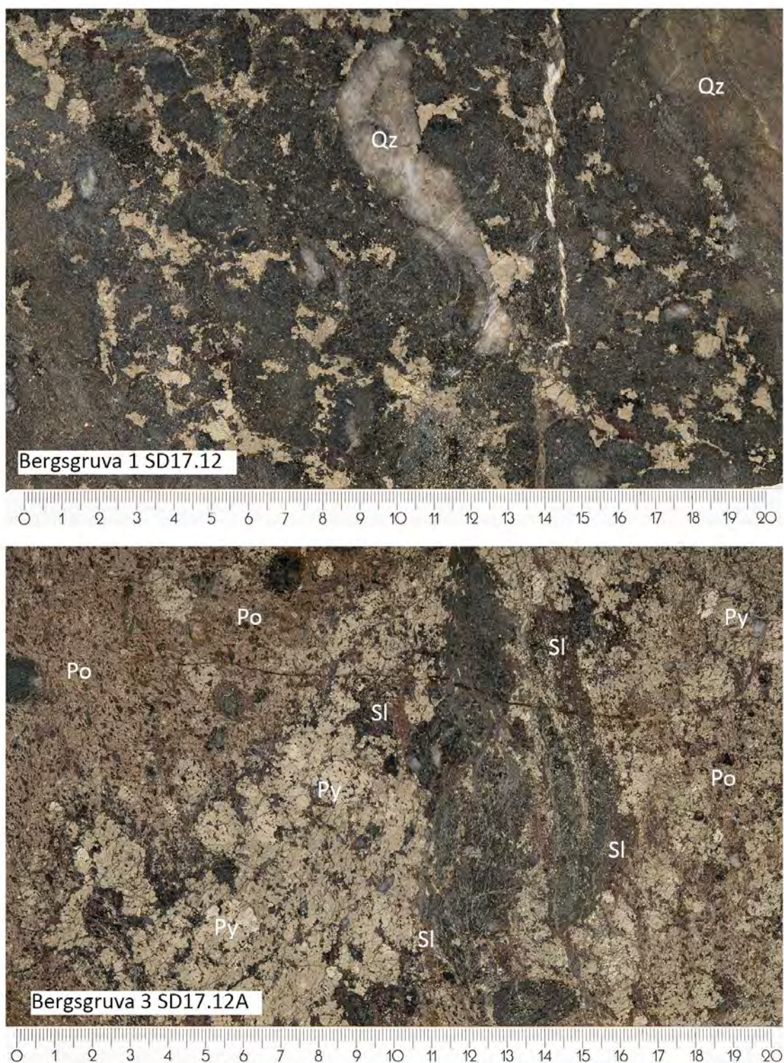
Figur 12: To ulike teksturer for sulfidmineraliseringen ved Bergsgruva: Bergsgruva 1 (øvre foto): Breksjelliknende mineralisering. Trolig er det et hydrotermalkvartsfragment midt i fotografiet, mens det er en kvartsrik bergart på høyre side (begge merket med Qz). Sulfidmineralene er en blanding av pyritt, kobberkis, sinkblende og magnetkis. Disse er sterkt sammenblandet i små korn i sulfid-domenene på fotografiet.
