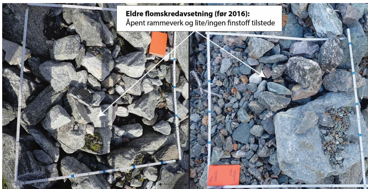
Figur 89: Bilder av eldre levée fra flomskred. Noter åpent rammeverk (hulrom) og kantrundet partikler.
