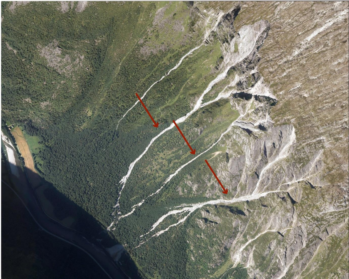
Fig. 9: Ortofoto fra 2013. Det har vært store flomskredshendelser som nådde ned til elven i tre av de fire aktive skredløpene. De røde pilene markerer skredløpene hvor det opplyst om store flomskredshendelser.
