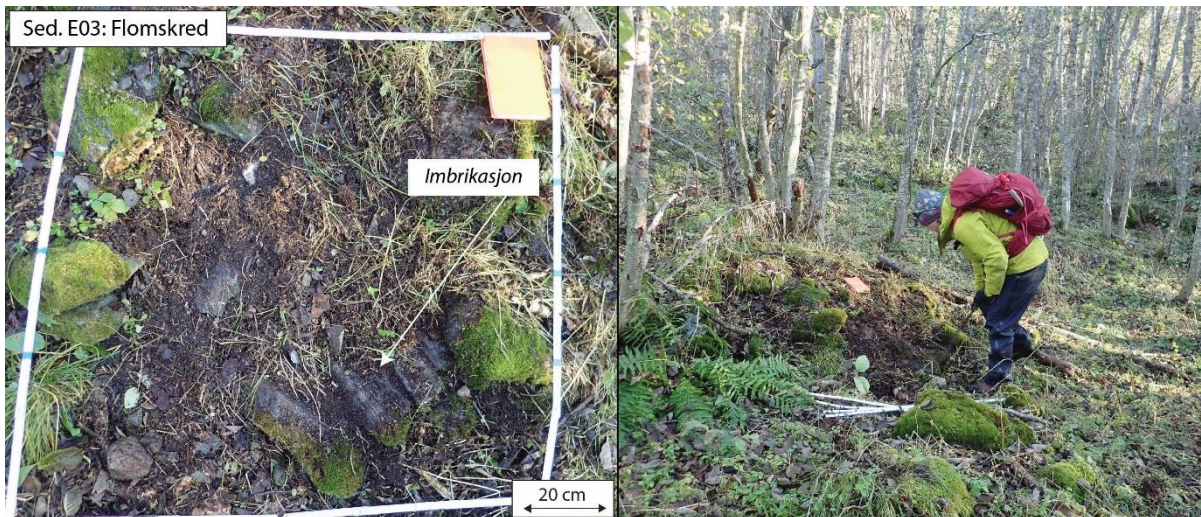
Figur 61: Venstre bilde viser overflatesedimentologien på ytterkanten av en flat tungeform avsatt fra flomskred. Sedimentene består av blokk og stein, dekket med moldjord og gress/mose. Synlige blokk viser fortsatt imbrikasjon. Høyre bilde viser fronten av tungeformen. Feltarbeid utført 17. oktober 2019.
