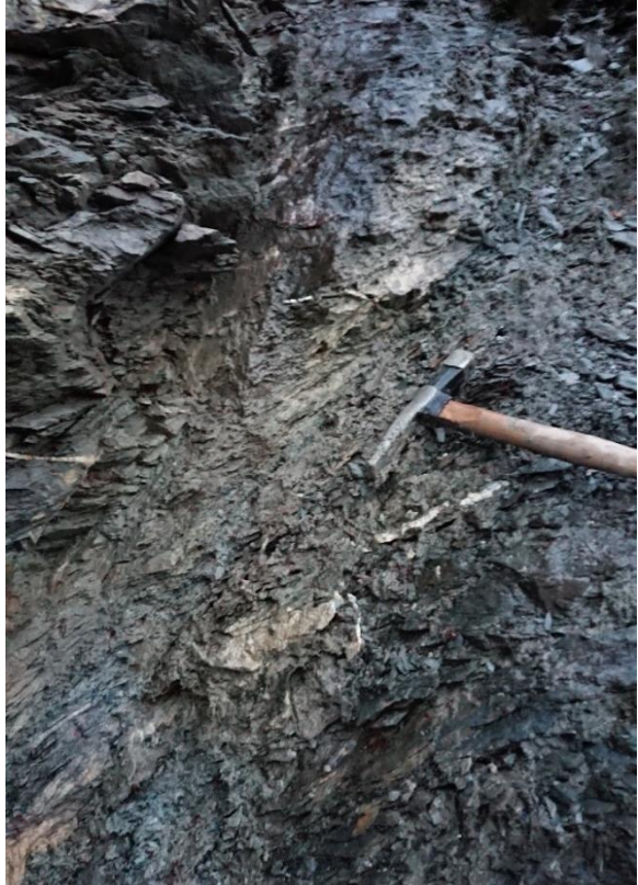
Figur 5-5: Geilhaugen steinbrudd (venstre bilde) med markert forkastningssone ovenfor personen i bildet. Sleppesonen er vist i nærbilde til høyre.
