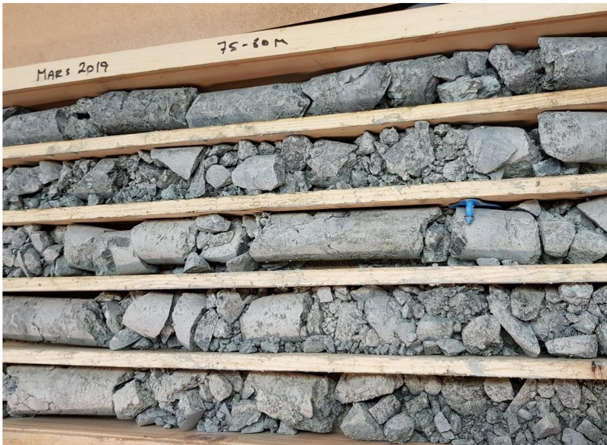
Figur 5-16: Kjerneboksen der prøve av forvitret prøve ble tatt på 79-79,5 m dyp (Sone B). Breksje kittet sammen med finstoff, inkludert leirmineraler.
