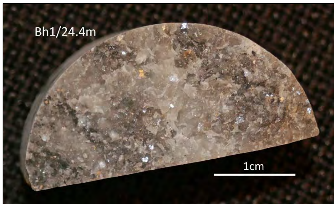
Foto av kjerneprøve fra borhull NL1 (Bh1) ved 24.4 m.
