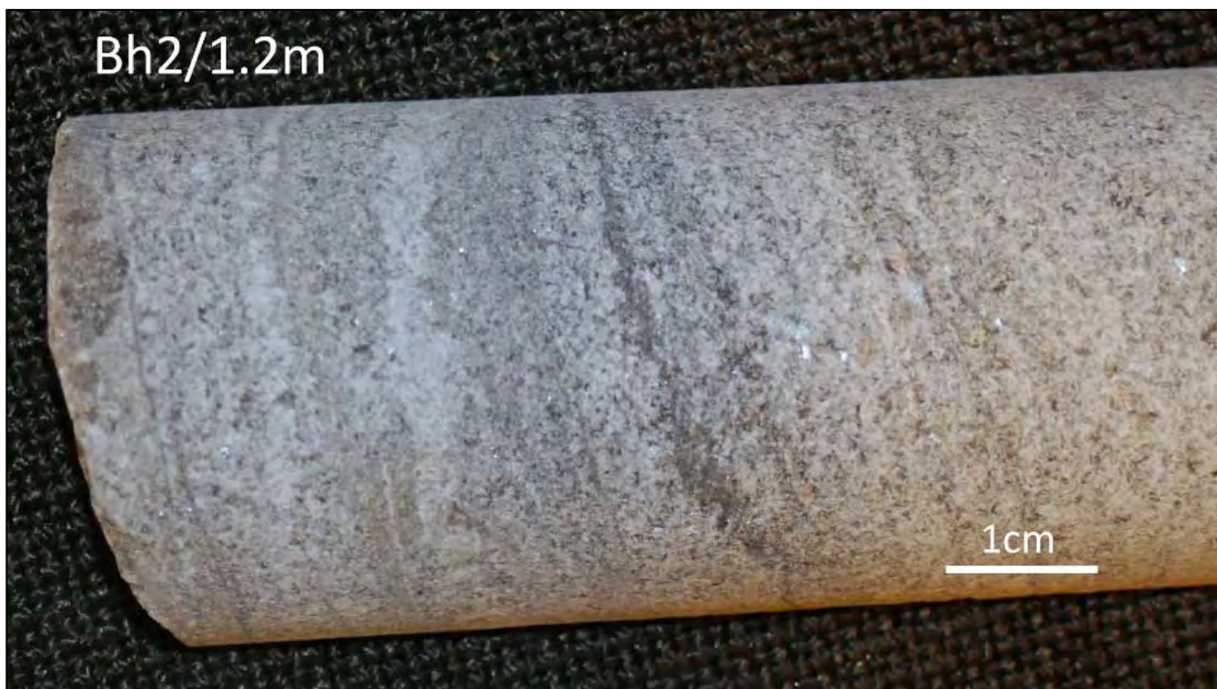
Foto av kjerneprøve fra borhull NL2 (Bh2) ved 1.2 m. Bergarten er en relativt lys, båndet kalkspatmarmor med til dels tett veksling mellom hvite og grå bånd.
