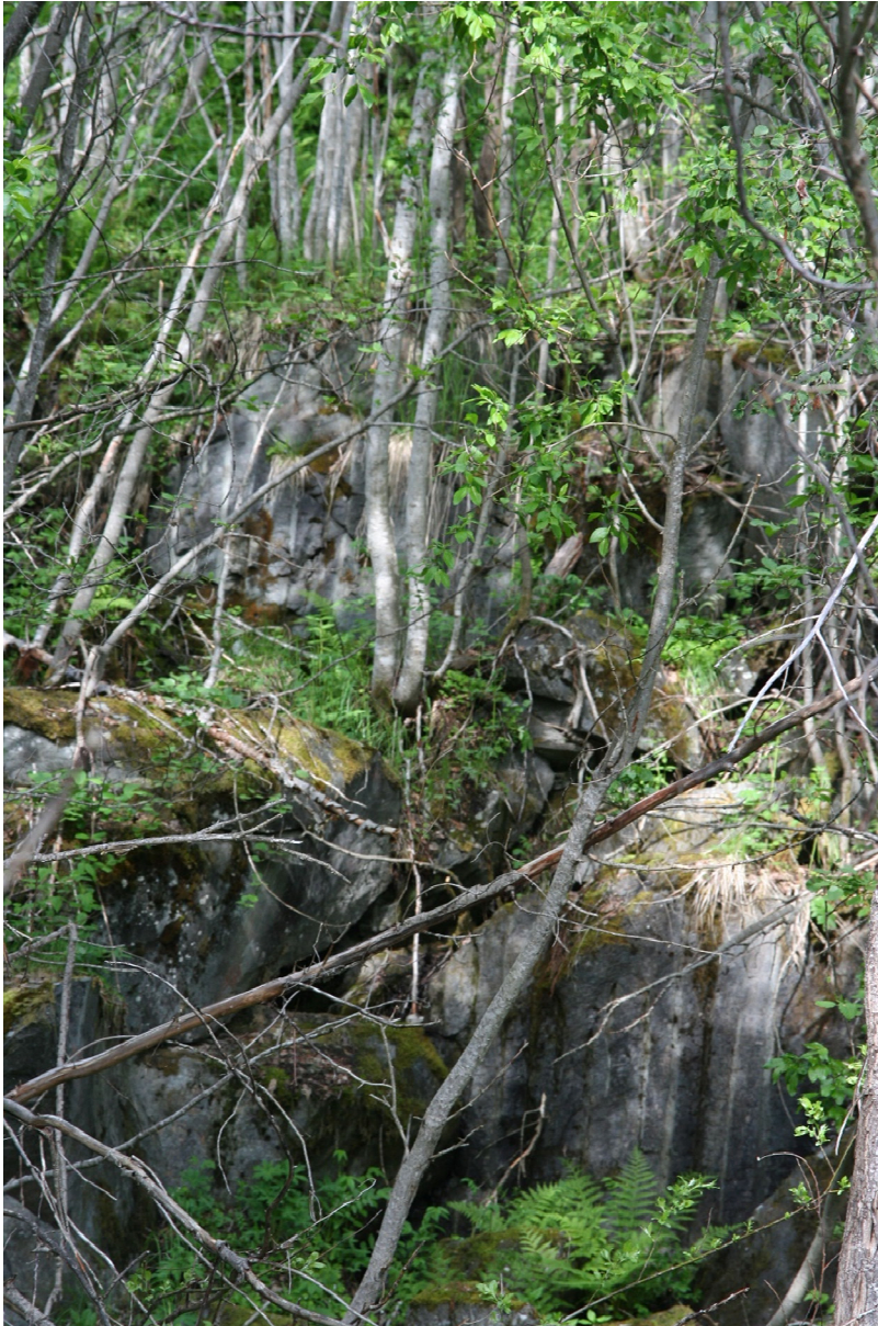
Figur 12. Eldre brudd drevet med tett sømboring nord for avdekket område. Bruddet ses ikke fra hovedbruddet og er sterkt gjengrodd. Hugge kvaliteten er ikke like god som i den sentrale delen av hovedbruddet.
