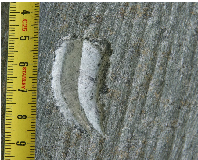
Figur 16b. Enkel test av huggekvaliteten. Testen viser at steinen ryr noe, men ikke fullt så mye som for kvalitet 3 (se figur 17b). Steinen er mer grovkornet enn kvalitet 1 og korn av amfibol rives ut av grunnmassen. Det samme skjer for større aggregater av dolomitt. Prøven inneholder 16% amfibol og 13% dolomitt.
