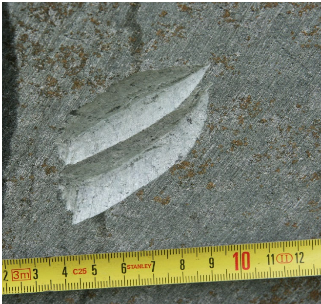
Figur 15b. Enkel test av huggekvaliteten. Huggekvalitet 1 som karakterisere kleber der er myk og jevn å bearbeide og som ikke ryr. Det er ingen harde knuter og aggregater, og ryggen som hugges fram er jevn og glatt. Kornstørrelsen for dolomitt er forholdsvis fin og fordelingen er jevn. Det er få linser og lag der dolomitt er konsentrert.
