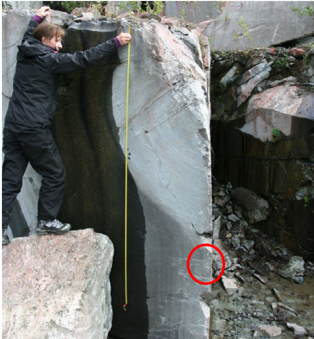
Figur 16a. Lokalitet 360 på en terrasse mellom mellomste og øverste bruddnivå. Den røde sirkel markerer hvor prøven er tatt. Testhuggingen er gjort på baksiden av framspringet. Dolomitt danner relativt store aggregater i bergarten, men de ligger fortsatt spredt og danner ikke sammenhengende lag og linser. Bildet er tatt mot sørøst. Målebåndet er strukket ut på 210 cm.
