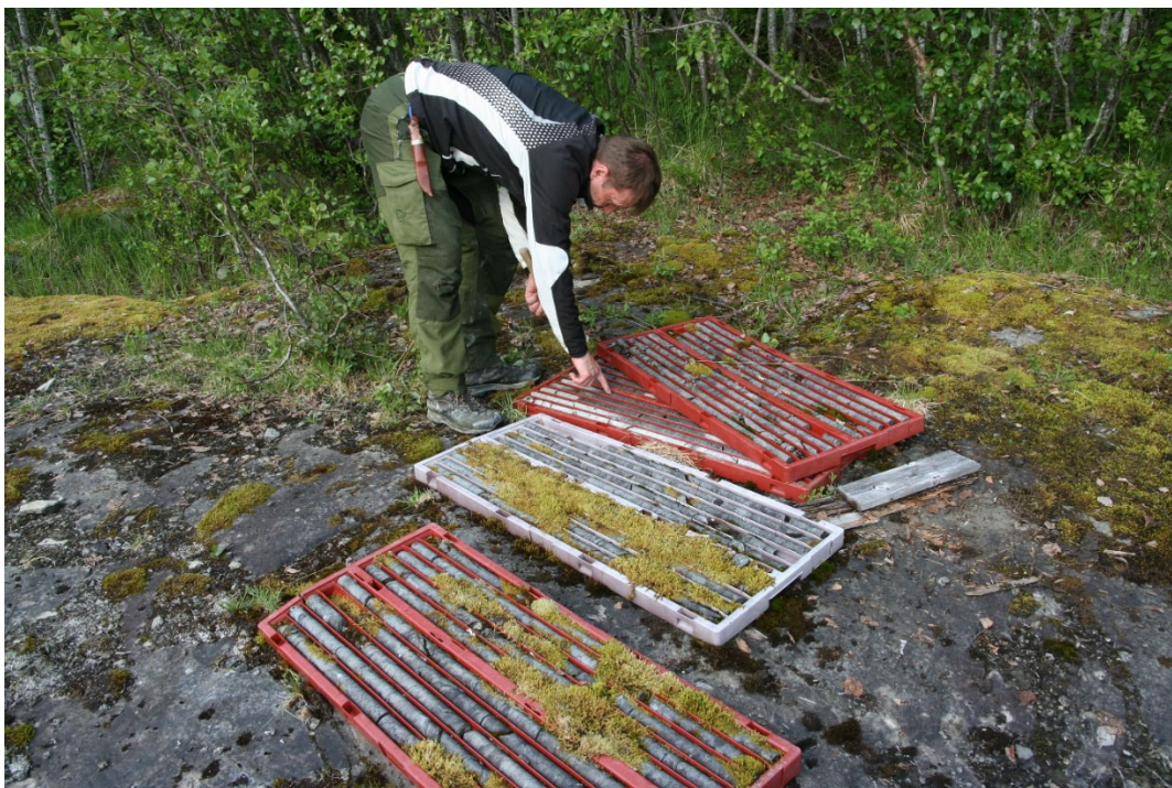
Figur 8. Borekjerner fra 1994 etterlatt i bruddet uten merking, men relativt uforstyrret internt i eskene. Mest sannsynlig er dette borekjerne 5/ 94 som er beskrevet i rapport av Søvegjarto (1996) der stemmer best overens med lokalitet og lengde på kjernen (ca. 40 meter)
