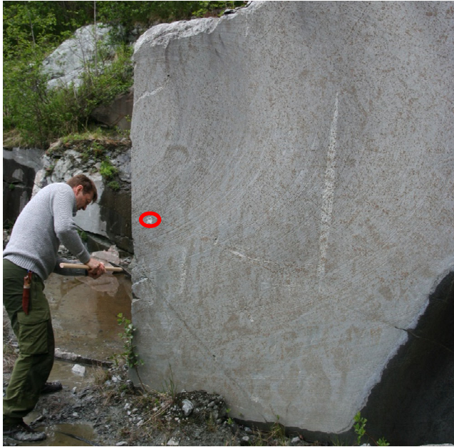
Figur 17a. Kvalitet vurdert i lokalitet 354 i den nordøstlige del av bruddet. Den røde sirkel markerer hvor testen er gjort. Prøven er tatt der personen higger. Bemerk mønsteret i de rustfargede flekker av dolomitt. Mineralene danner uregelmessige og til dels sammenhengende aggregater i form av lag og linsjer som vil gi uregelmessig hardhet. Bildet er tatt mot nord.
