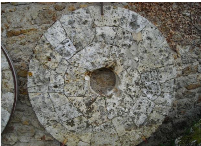
Figur 138. Kvernstein laga av mange små bitar. La Ferte i Frankrike. Foto: Atle Ove Martinussen.
