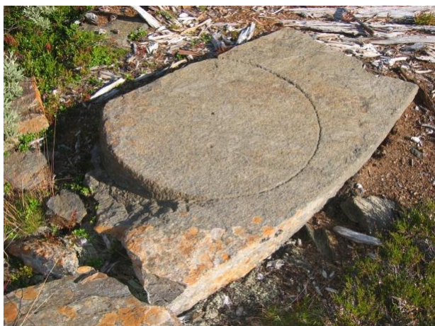
Figur 130. Klargjort opprissing og nedhogging stykke for stykke langs sirkelen. Foto: G. Meyer.
