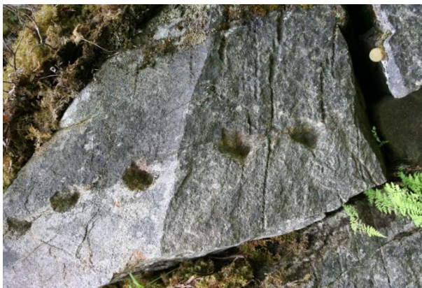
Figur 81. Blokk klargjort for splitting/kløyving (Saltdal). Foto: G. Meyer.
