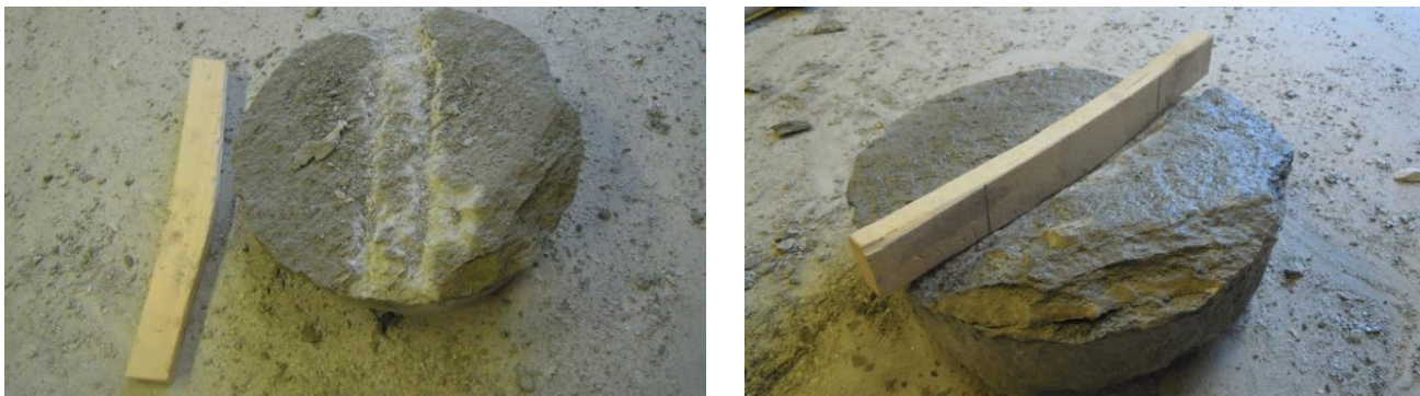
Figur 140. Hoggning av renna langs diamateren på steinen til tremalen passar. Foto: T. Løland.
