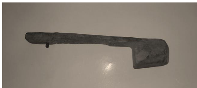
Figur 144. Strokk, rissemål til bruk for å gjere steinen jamtjukk.
