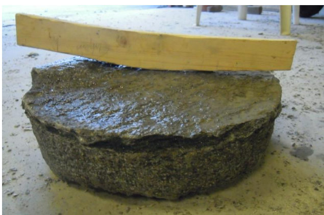
Figur 139. Oversteinen klar for tilhogging av maleflata.
