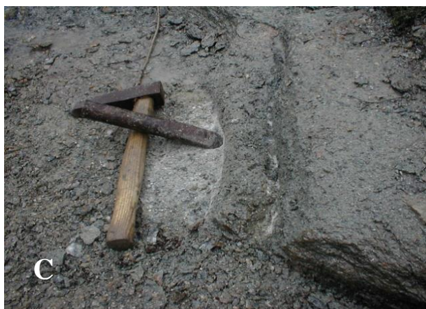
Figur 121. Stegvis rydding av steinflata for klargjering til neste kvernstein.
