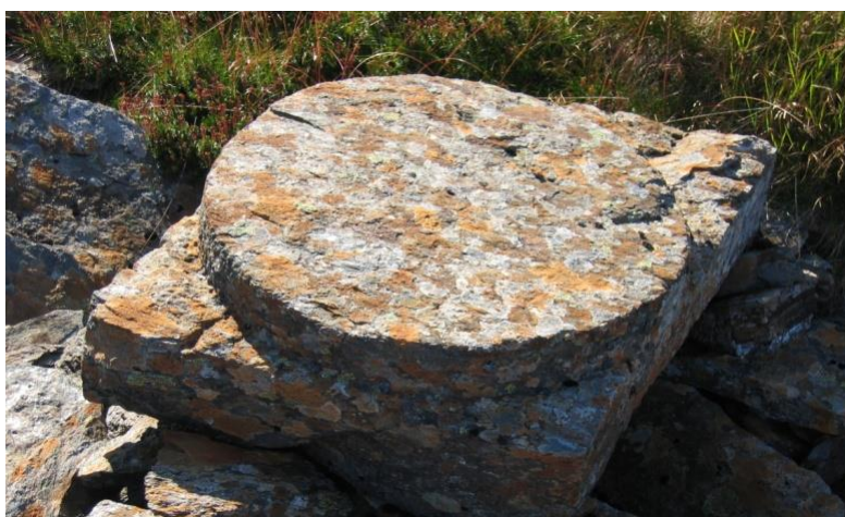
Figur 66. Maksimal utteljing på diameter gir loddrett sidevegg, Selbu. Foto: G. Meyer.
