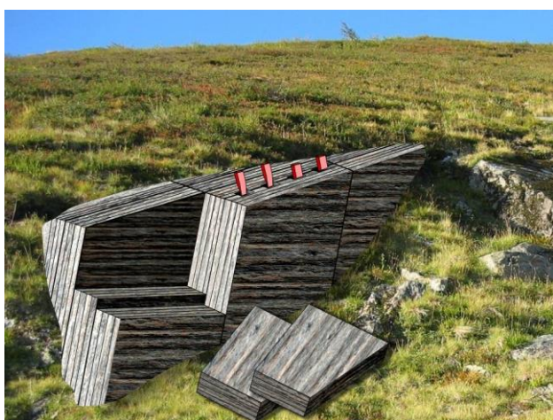
Figur 124. Splitting av blokk med kile. III. Grenne og Meyer (2009).
