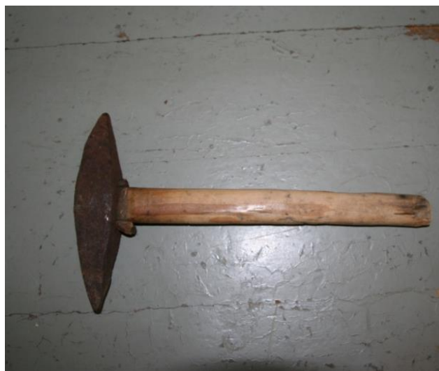
Figur 13. Lite hoggejern (Kvennjern) Selbu. 27 cm frå spiss til spiss og veg 2000 gram inkl. skaft.
