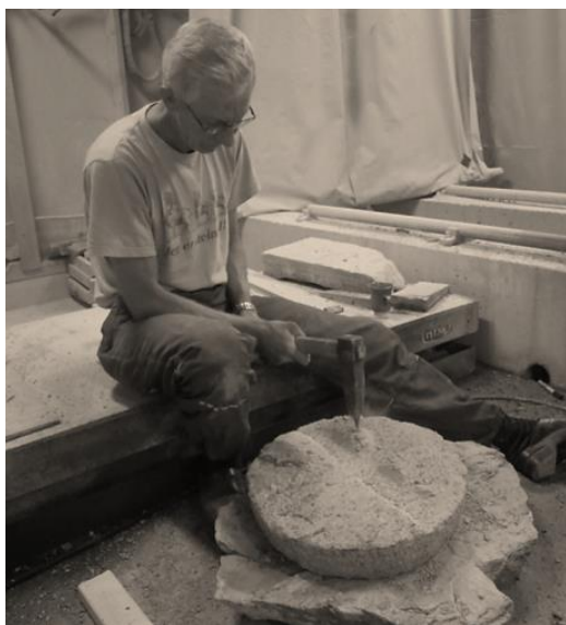
Figur 142. Nøyaktig nedhogging av maleflata med tremalen som kontrollør.
