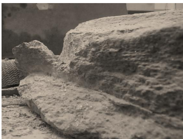
Figur 132. Eit V-spor langs sidekanten. Slå av steinstykket frå utsida.
