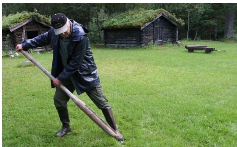
Figur 32. Ause av tre til tømning av steinbrota for vatn. Foto: Gurli B. Meyer.
