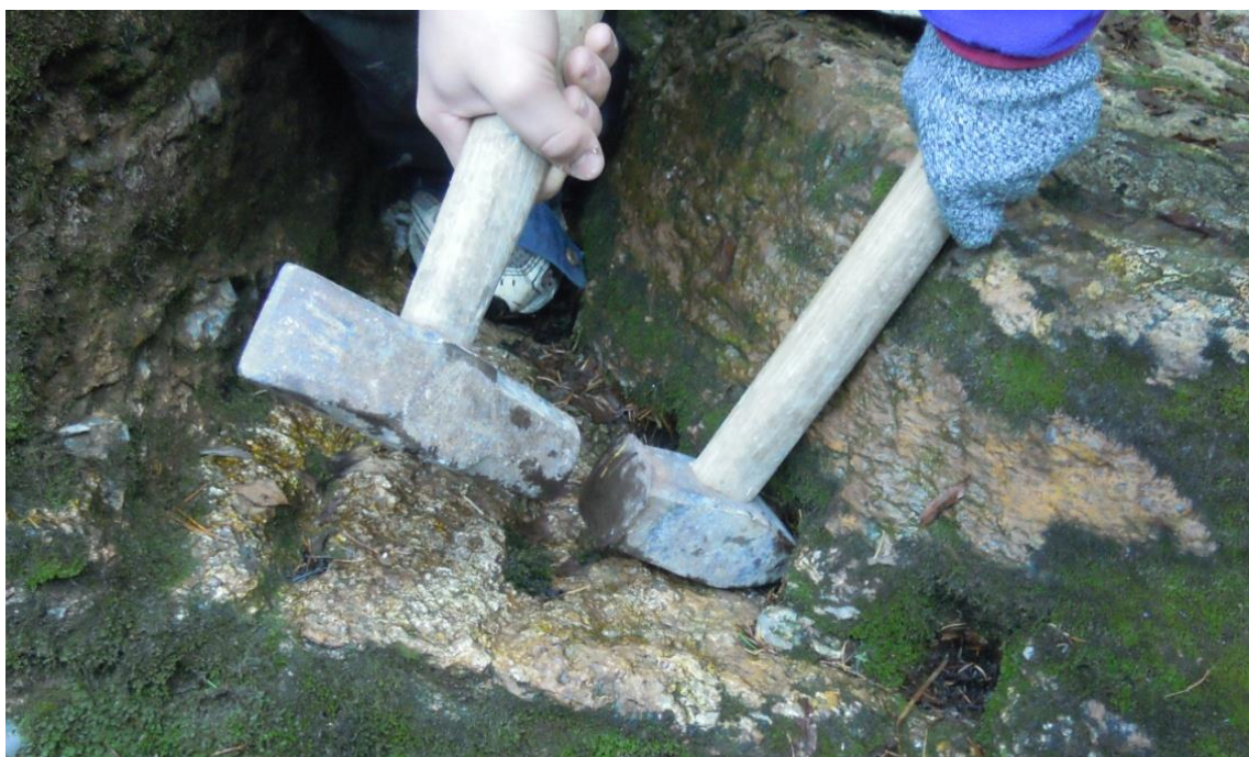
Figur 82. Demonstrasjon for fotograf av mulig løyseverktøy (her ein sett) med skaft.
