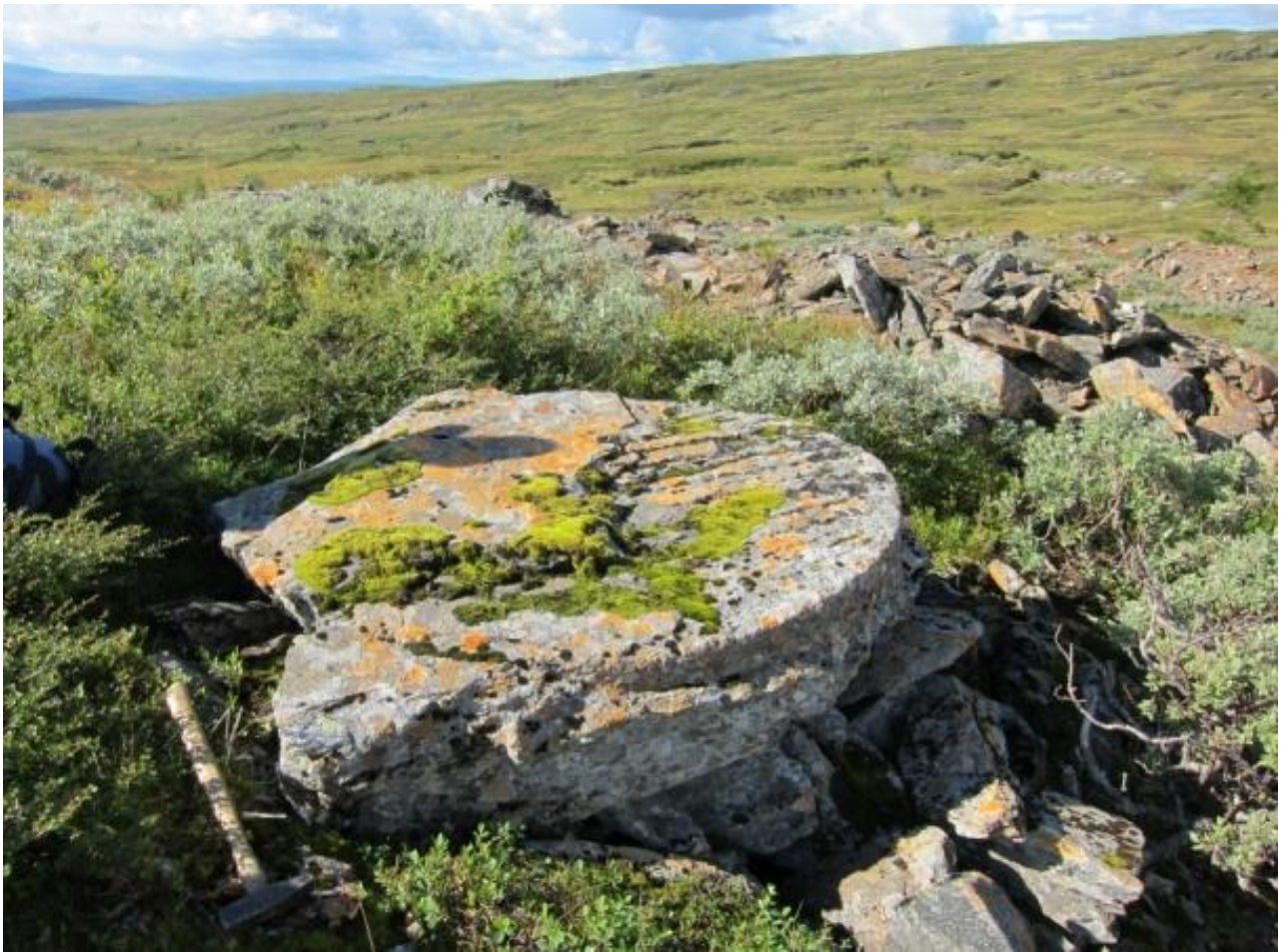
Figur 127. Steinemne i Selbu der maleflata blir plana i takt med nedhogging av steinen. Foto: T. Grenne.
