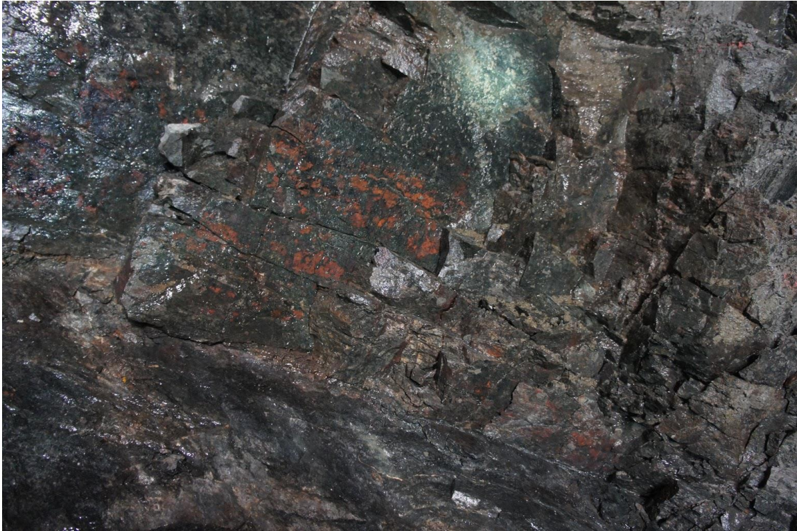
Figur 19: Bilde fra stoffen ved PEL 4717. Rødfarge (Hematitt) opptrer på begrensede flater som sprekkebelegg i til dels dårlig fjell.
