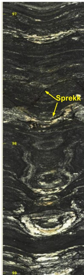
Figur 12. OPTV bilder fra KH-01-17 som viser sprekker ved 77, 78 og 98 m.
