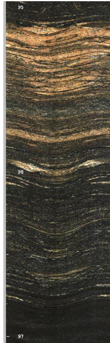
Figur 24. KH-02-17, Optv-bilde av foldet struktur (venstre) og tydelig foliasjon mot s-sø (høyre).
