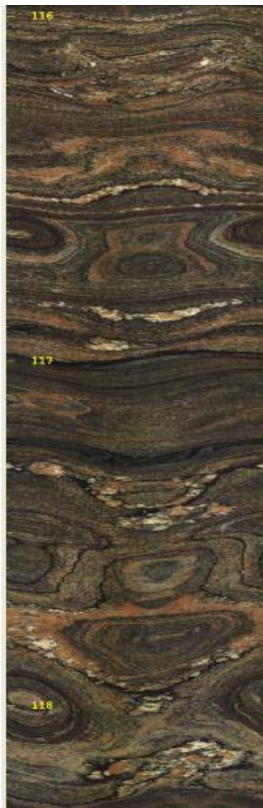
Figur 24. KH-02-17, Optv-bilde av foldet struktur (venstre) og tydelig foliasjon mot s-sø (høyre).
