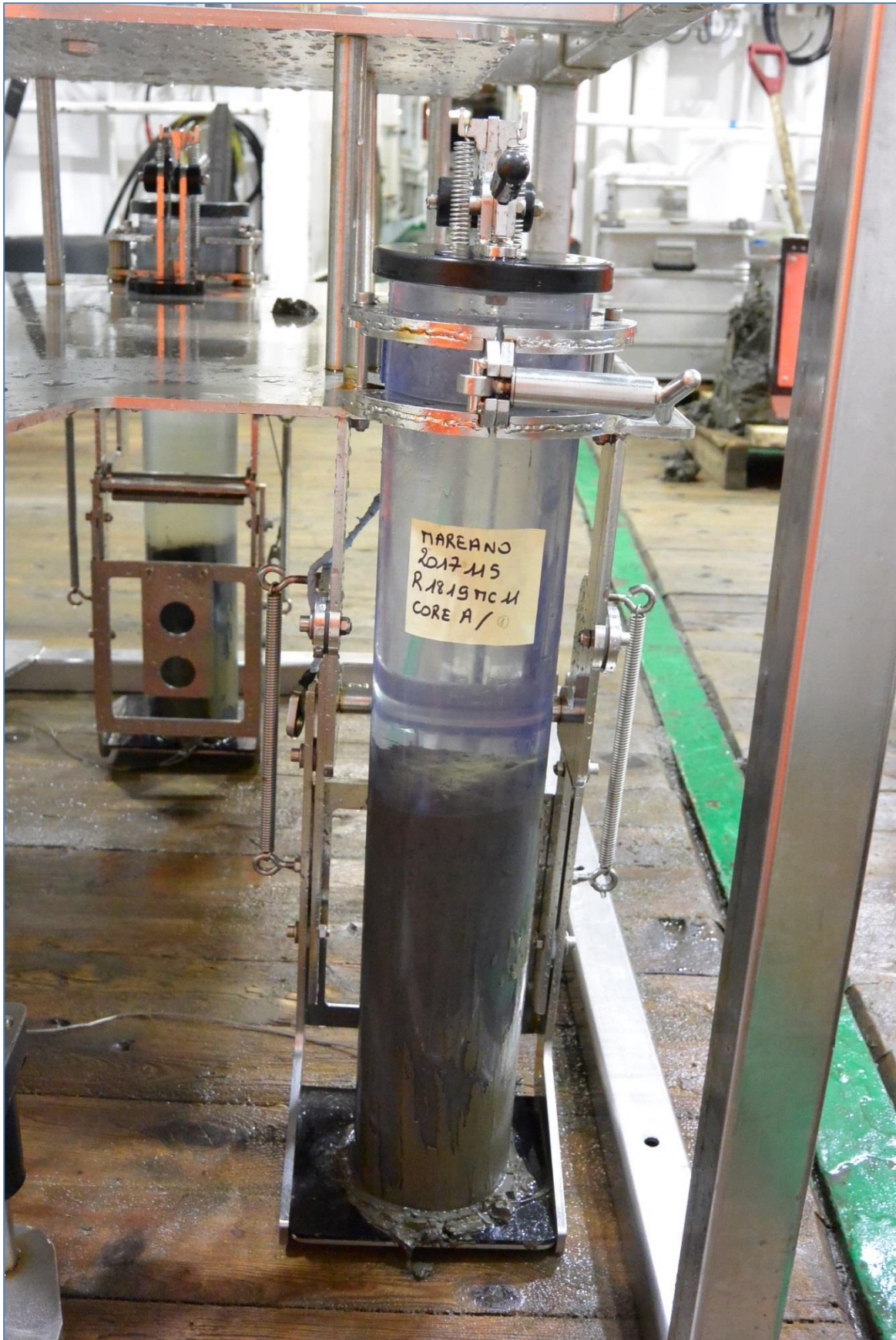
Figur 3. Sedimentkjerne A fra stasjon R1819MC011 tatt med multicorer fra MAREANO Øst. Lengden på sedimentkjernen er 32 cm ifølge dekksluggen.
