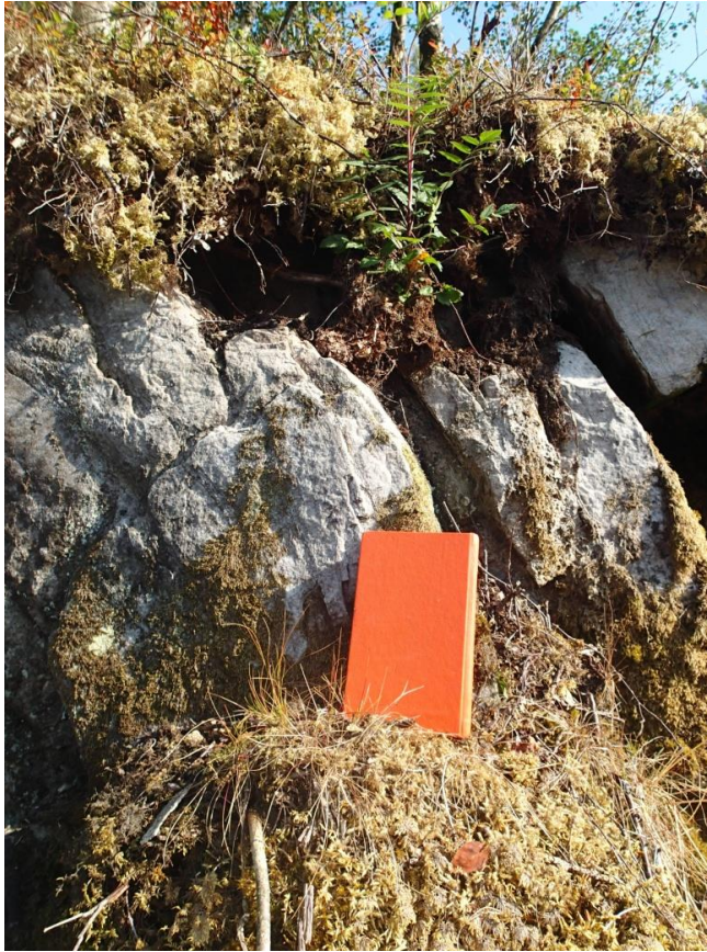
Figur 6 Blotning 50 meter nordvest for bekken viser tyktspaltende skifer med ujevn kløv
