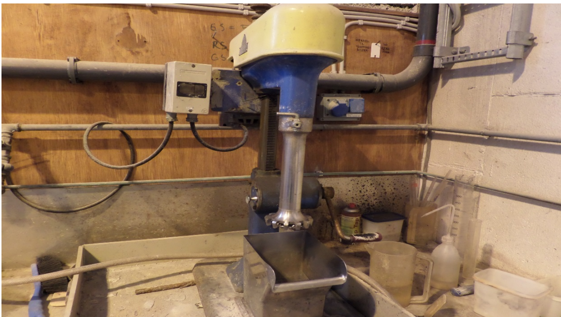
Figur 10. Bildet viser en standard Denver lab flotasjonsmaskin som ble anvendt i flotasjonsforsøkene,
