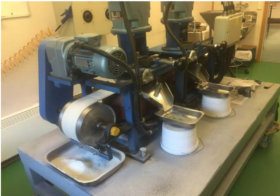
Figur 11. Bildet viser en såkalt belte-disc magnet produsert av Master Magnets Ltd som ble anvendt i forsøkene med tørr magnetbehandling av flotasjonskonsentratene.
