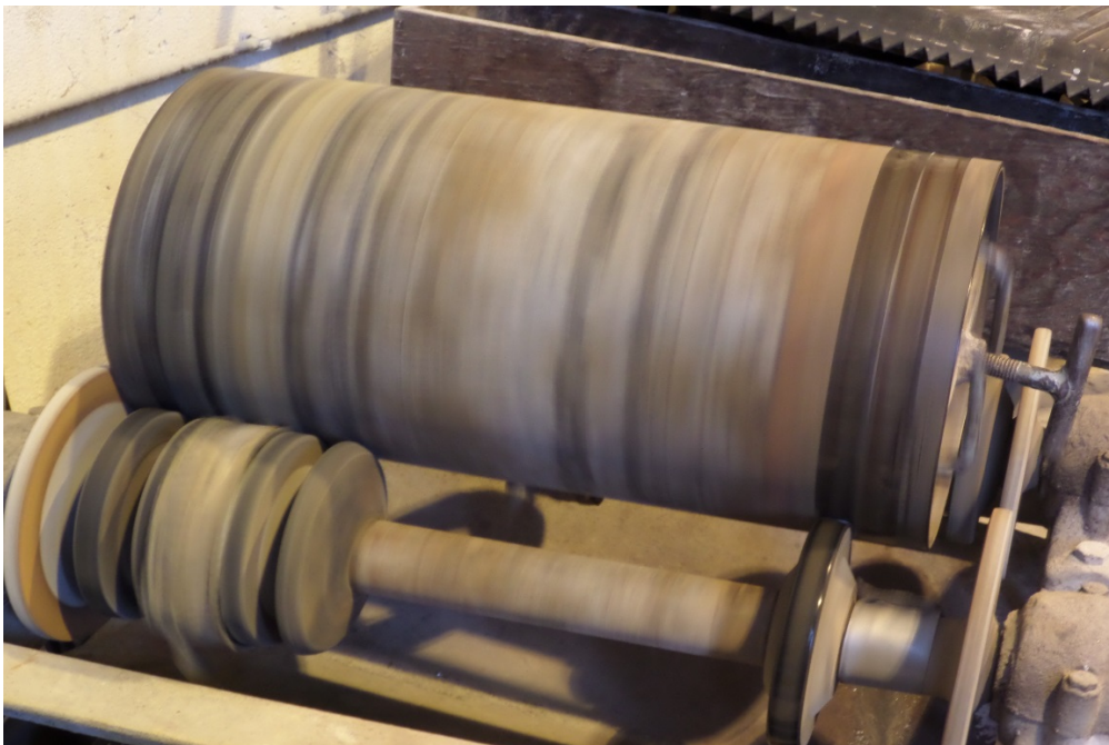
Figur 9. Bildet viser den 35 liter store stavmøllen i rustfritt stål som ble brukt i den våte nedmalingen av minus 8 mm fraksjonen.
