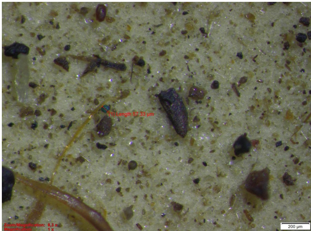
Figur 4. Sferisk grønn mikroplastpartikkel omtrent midt i bildet. Prøve R1070BC045.
