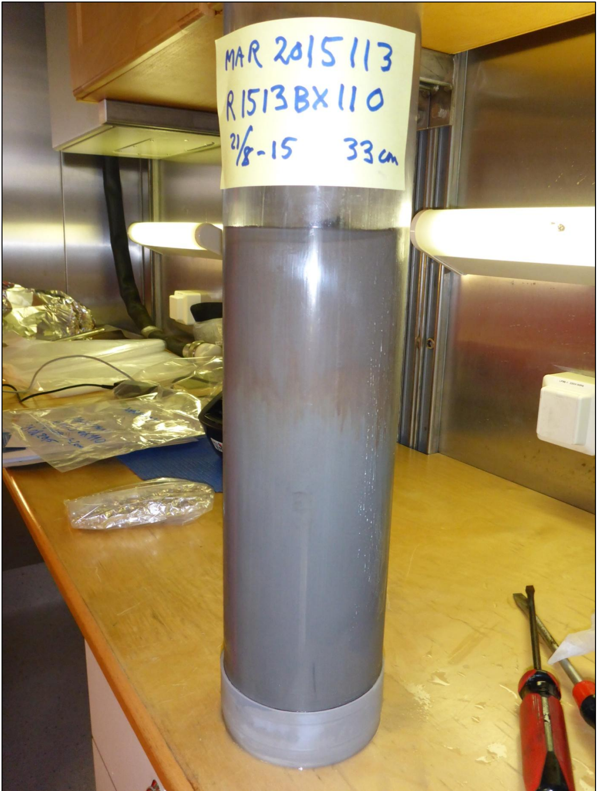
Figur 2. Sedimentkjerne fra bokscorer på stasjon R1513BX110 fra Storegga i Norskehavet, er en av de 10 prøvene brukt for analyse av mikroplast i sedimentene. De øverste 3 cm i sedimentkjernen ble tatt ut til analyse.
