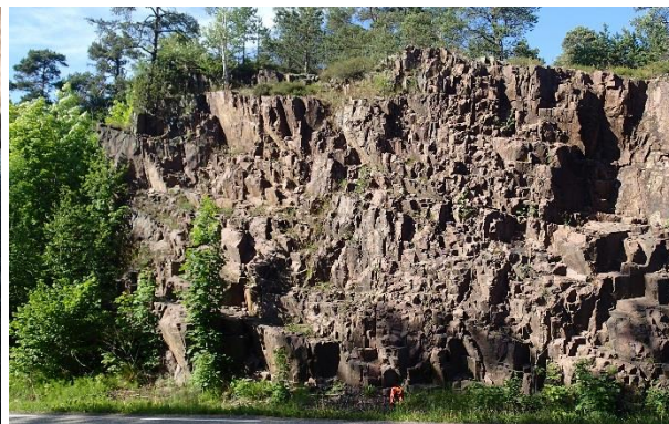
Figur 29: Fjellskjæringen ved Hesby vegskjæring som ligger sør for området er karakterisert av en rød, finkornet kvartssyenitt med porfyrisk karakter. De ble tatt prøve til mekanisk analyse ved denne lokaliteten.
