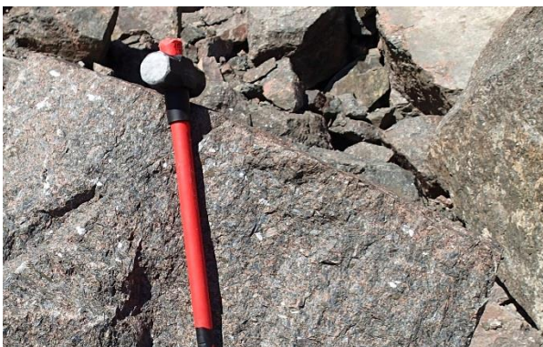
Figur 6: Grå-blå monzonitt med porfyrisk karakter som finnes i midtre deler av dagbruddet. Sleggehammer for skala (lengde ca. 90 cm).
