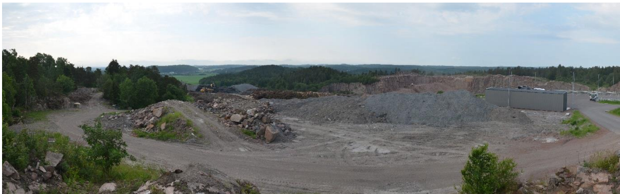
Figur 23: Det undersøkte området Taranrød øst er fullstendig dekket med skog (til venstre i bildet); i midten av bildet sees Tønsberg fyllplass og bruddkanten av Taranrød dagbruddet bak deponiet. Hovedbergarten i området er en rødlig-grå kvartssyenitt.
