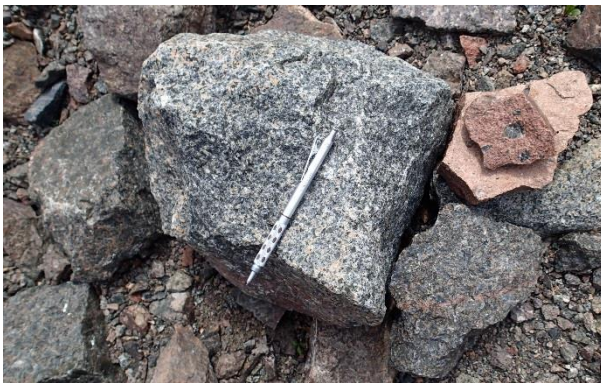
Figur 4: Håndstykker av bergarter som finnes i Himberg pukkverk. Blokken som er størst er grå monzonitt, til øverst til høyre er en rødlig syenitt, og nederst en mørk monzonitt.
