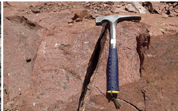
Figur 5: Rødlig syenitt med porfyrisk karakter som finnes i den nordlige delen av dagbruddet (høyre side av Figur 3).
