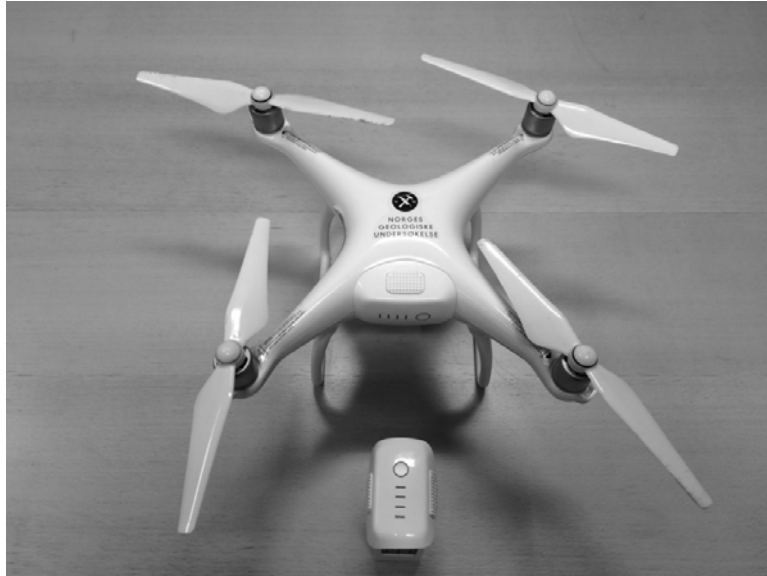
Figur 1: Drone brukt til å skaffe GPS rektifiserte bilder fra luften: DJI Phantom 4.
