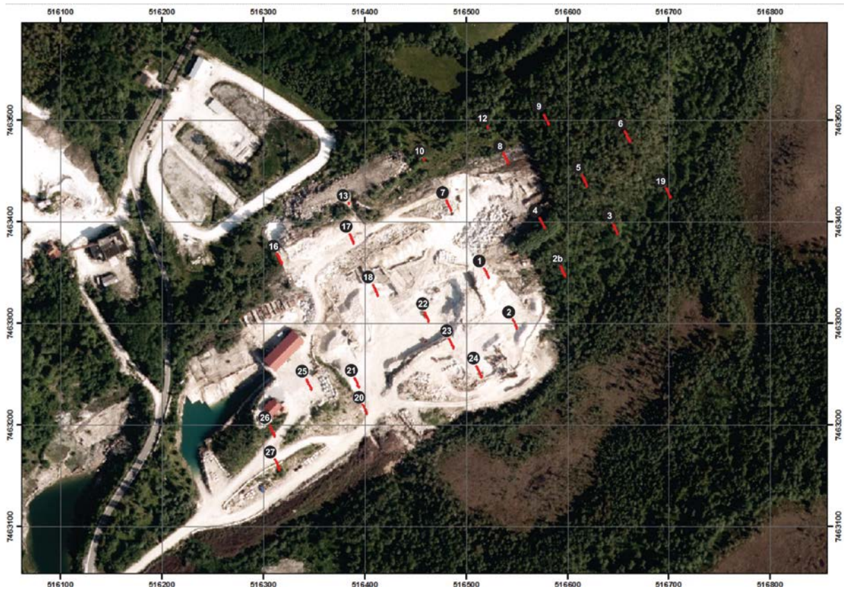
Figur 9: Utsnitt fra Norge i bilder som viser bruddet med 25 borehull som faller mot sør.
