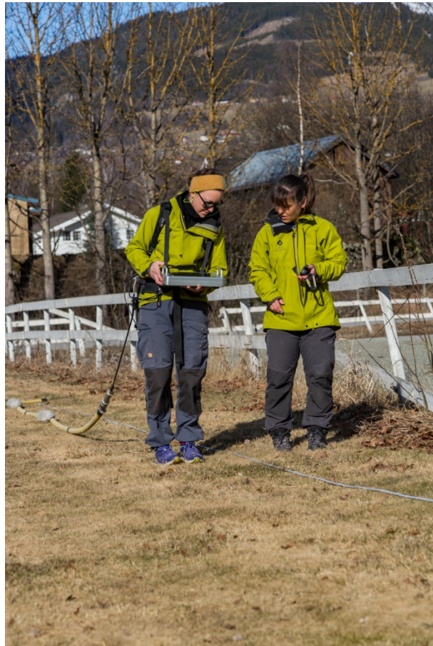
Innsamling av georadar data i Gol med Malå RTA 'snake' antenne.
