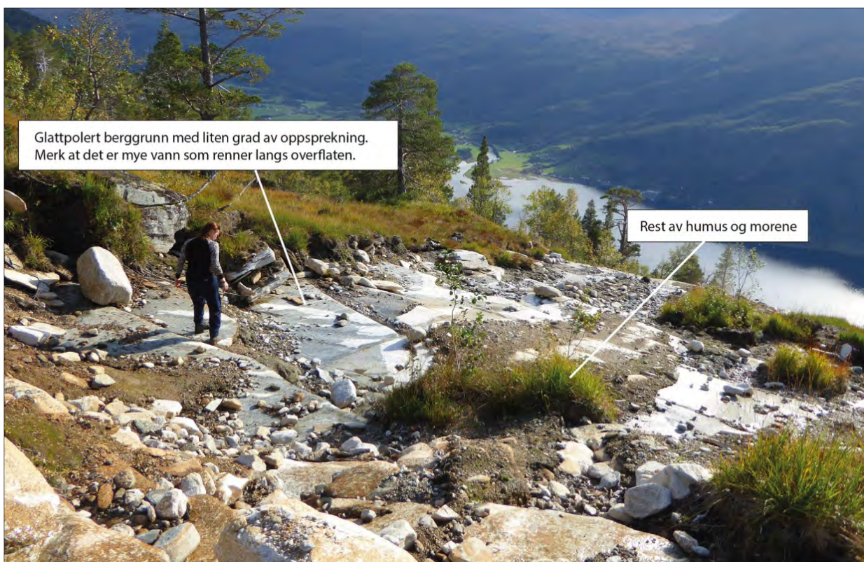
Figur 54: Foto tatt fra løснеområdet ned mot Todalsfjorden. Legg merke til at berggrunnen er lite oppsprekt med en glattpolert overflate. Foto: Gro Sandøy, 29. september 2015.
