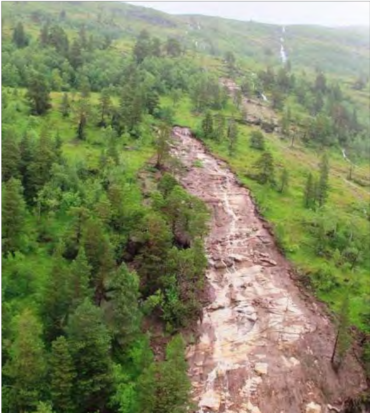
Figur 49: Oversikt over løsneområdet. Bildet ble tatt fra helikopter på skredhendelsesdagen. Legg merke til store mengder vann som renner nedover skredløpet. Dog er det ikke mulig å se noen bekkeløp i terrengoverflaten bak løsneområdet. Foto: Terje Bargel, 31. juli 2013.
