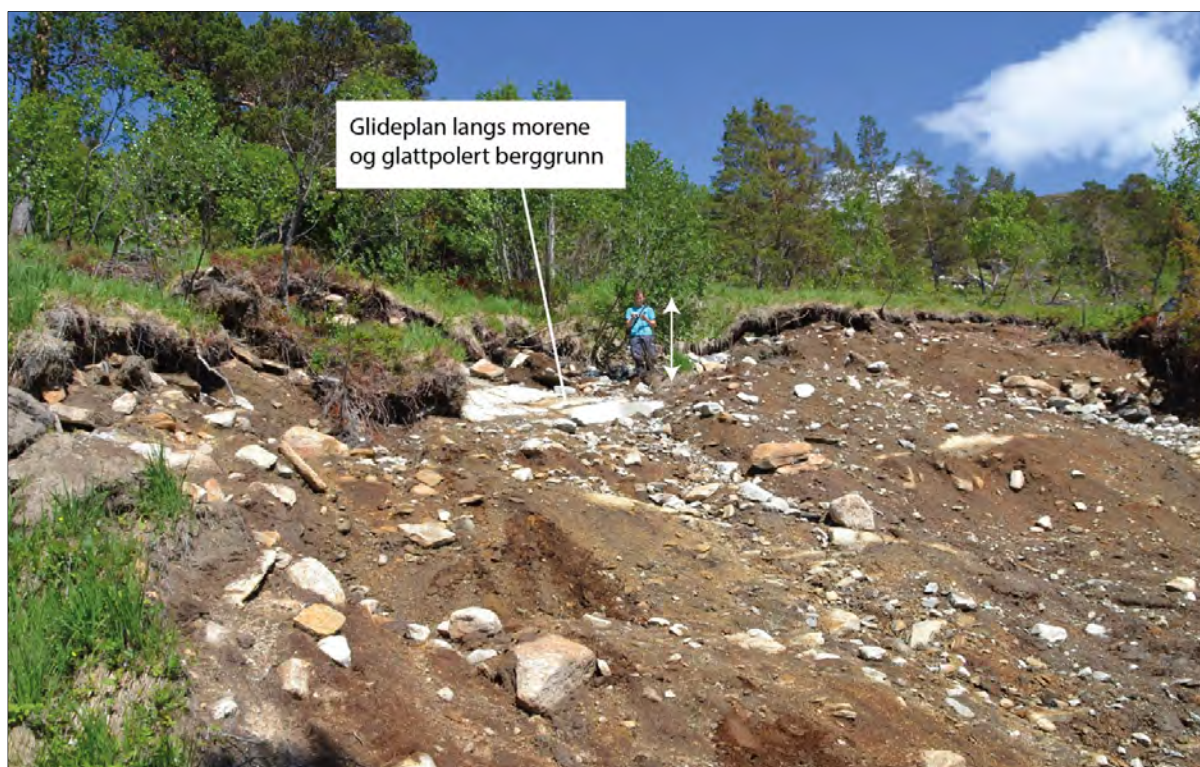
Figur 51: Foto av løснеområdet. Bakkanten består i en 16 m bred bruddkant med 0,2 til 1 m høyde. Foto: Tore Medgard, 8. juni 2014.
