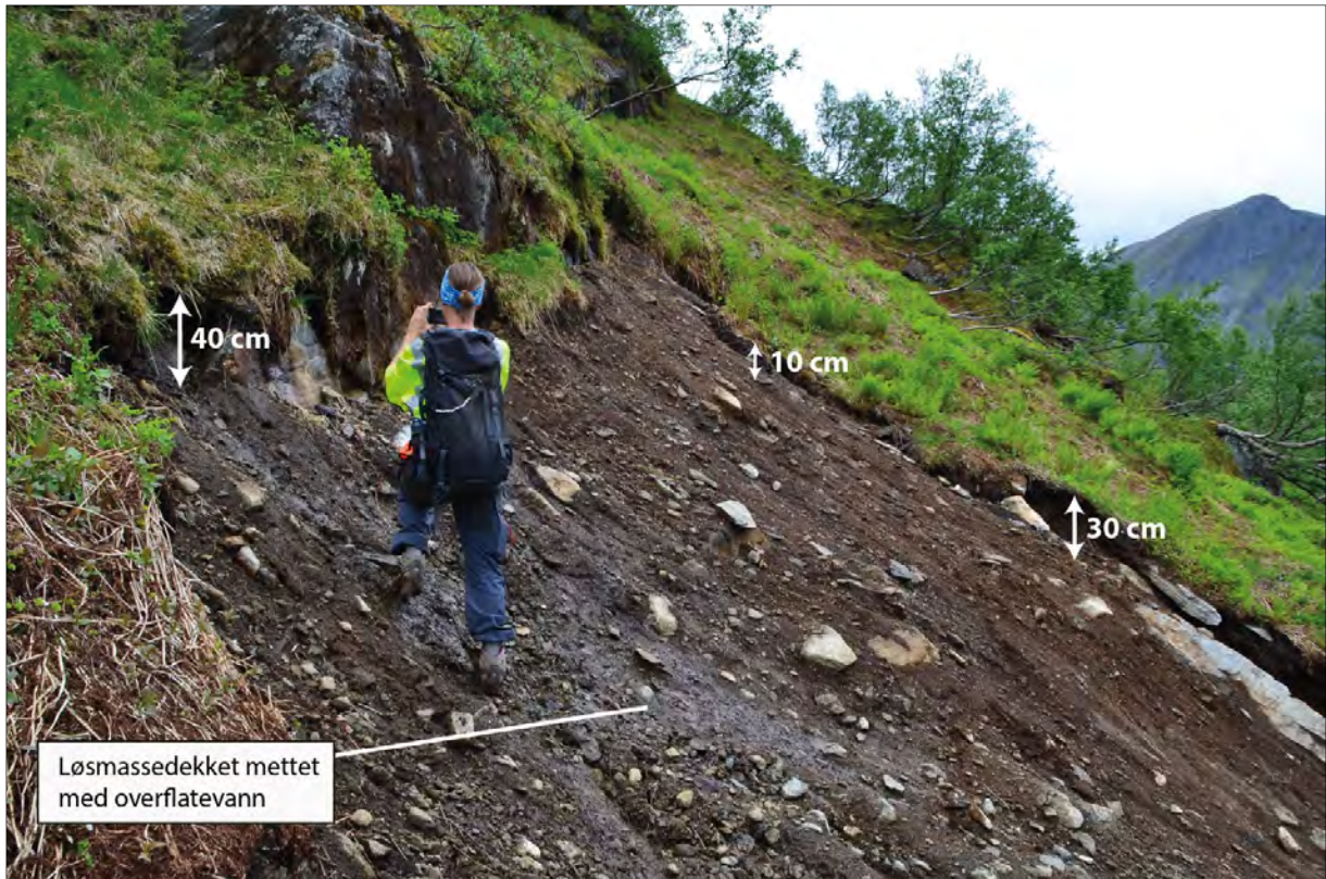
Figur 67: Nærbilde fra bakkanten. Legg merke til gjenstående brunlig, humusrikt, diamikt materiale som er svært vannmettet. Langs bakkanten har det glidd ut opp til 40 cm, mens mektigheten avtar til 10 cm ved de laterale skredkantene. Foto: Tore Medgard, 6. juni 2014.
