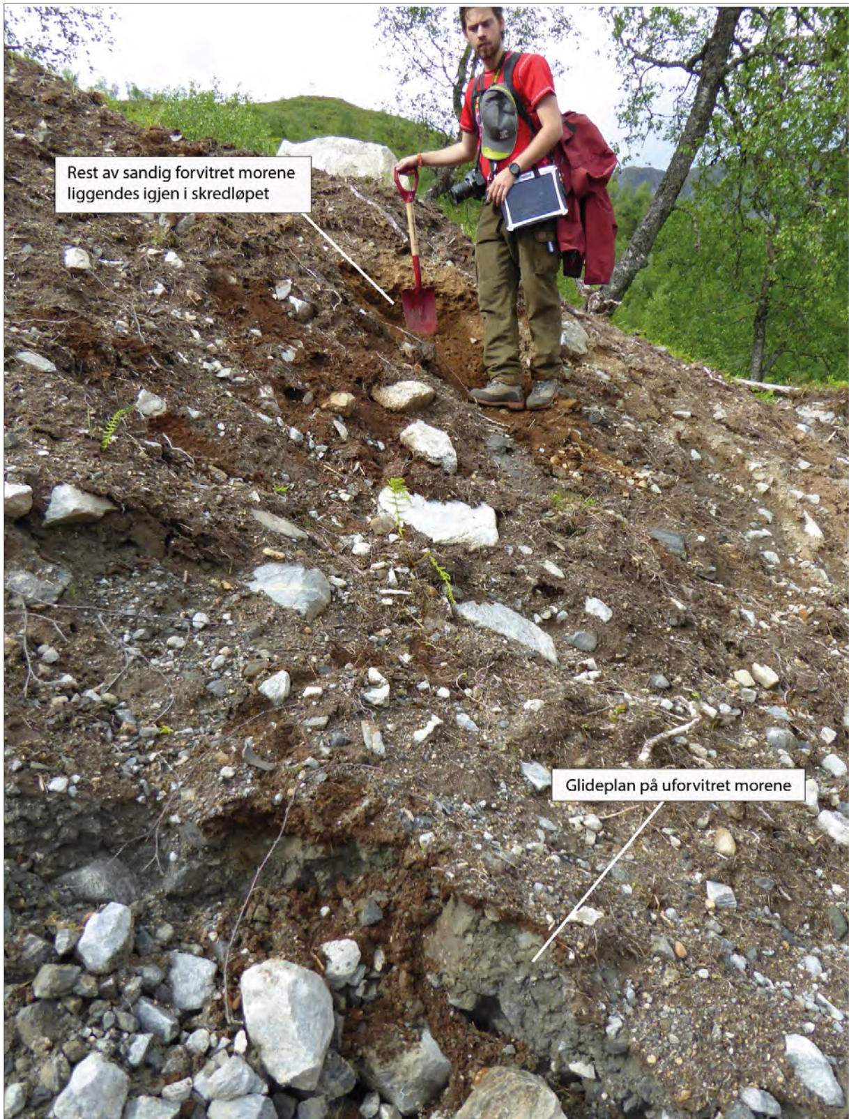
Figur 71: Eksempel fra midtre del (400 moh.) av skredløpet med tydelig glideplan ovenpå på konsolidert morene (lag 3). Massene som har glidd ut består av sandig forvitret morene (lag 2) og et tynt humuslag (lag 1). Foto: Gro Sandøy, 6. juni 2014.
