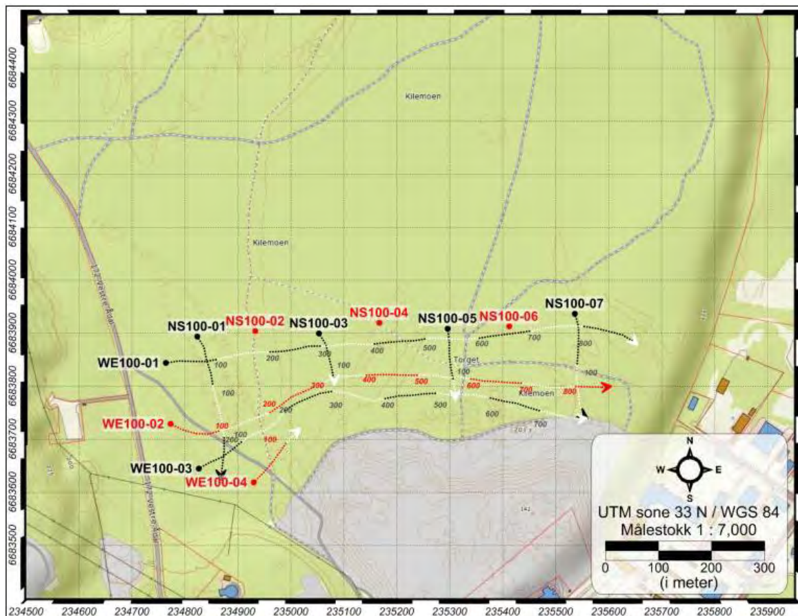
Figur2. Oversiktskart med plassering av profiler med 100Mhz antenne.
