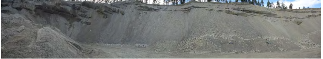
Bilde 4. Bilde av stoffen da georadarmålingene ble utført. Utrast materiale hindrer innsyn i materialsammensetningen.
