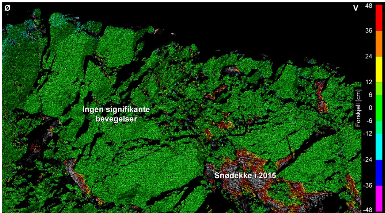
Figur 16: Bevegelsesmålinger på det ustabile fjellpartiet Svaddenipun: detaljbilde av den øvre, østlige delen av fjellpartiet der det finnes flere store blokker avgrenset av åpne sprekker (se Figur 14c), men som ikke viser signifikant bevegelse.
