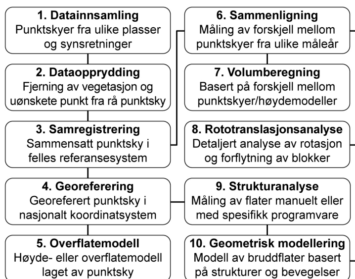
Figur 4: Arbeidsflyt for innsamling og analyse av bakkebaserte laserskannerdata (basert på Conforti 2005, Oppikofer m.fl. 2012). Trinn 1-5 og 9 utføres på punktskyer fra samme måleår. Trinn 6-8 og 10 trenger flere målinger fra ulike år for å beregne forskjeller og volumer, og lage en geometrisk modell av bruddflatene som avgrensner et skred.
