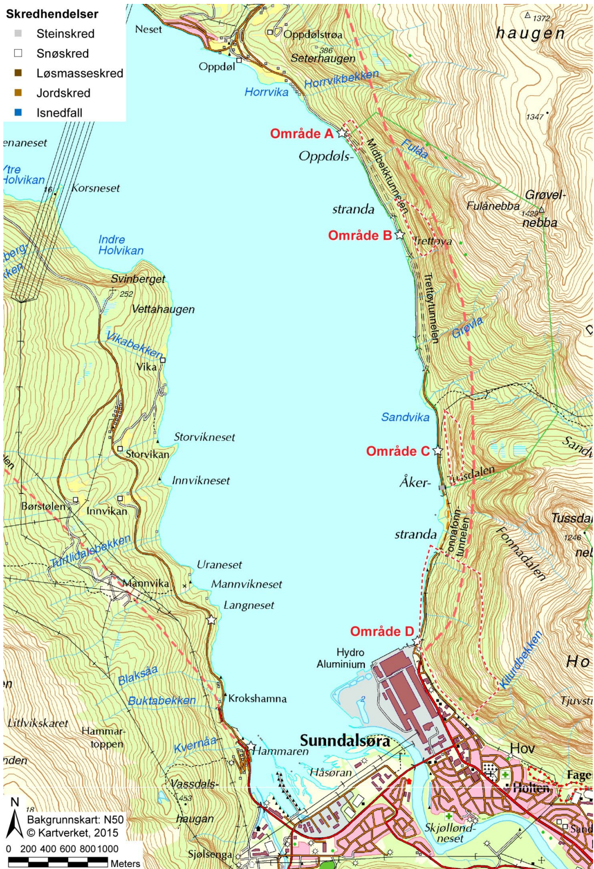
Figur 32: Kart over testområdet Oppdølstranda: den skredutsatte veistrekingen er inndelt i fire områder A, B, C og D (røde stiplede linjer). Seks plasseringer av bakkebasert laserskanner er vist med hvite stjerner. Historiske skredhendelser fra den nasjonale skredhendelsesdatabasen er vist med ulike punktsymboler for forskjellige skredtyper.
