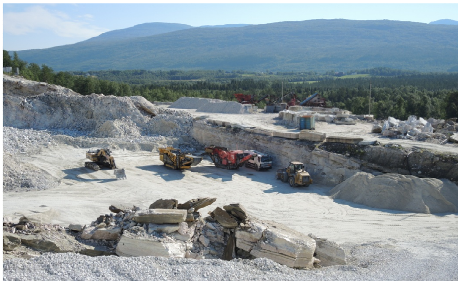
Figur 7 Bruddet ved Løvgavlen hvor det tas ut kalkstein til fyllmasser og pyntestein.
