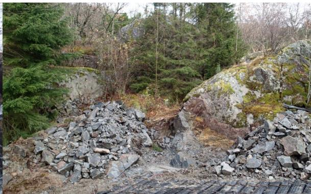
Figur 12: Prøvelokalitet Krossnes (pkt 13). Steinoverflaten er ganske forvitret, men det kan forventes mindre forvitring og kanskje sterkere stein mot dypet.
