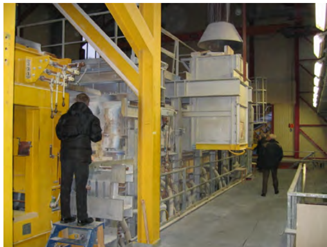
Figur 1. Bedriftbesøk var en nødvendig del av Idégruppens arbeid. Her ved PQ Silicates anlegg i Glomfjord hvor det ble produsert vannglass, eller hydrert natriumsilikat, fra importert kvartssand som eventuelt kunne produseres fra kvartsforkomster i Nordland.
