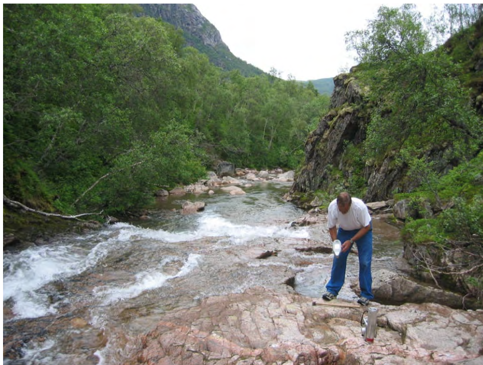
Figur 50. Oppfølging av Zr-anomali langs elv i Fiskfjorden i Tjeldsund kommune. Måling av Zr-innholdet i bekkesedimenter og fast fjell ble utført av L. Furuhaug med bærbar XRF analysator.
