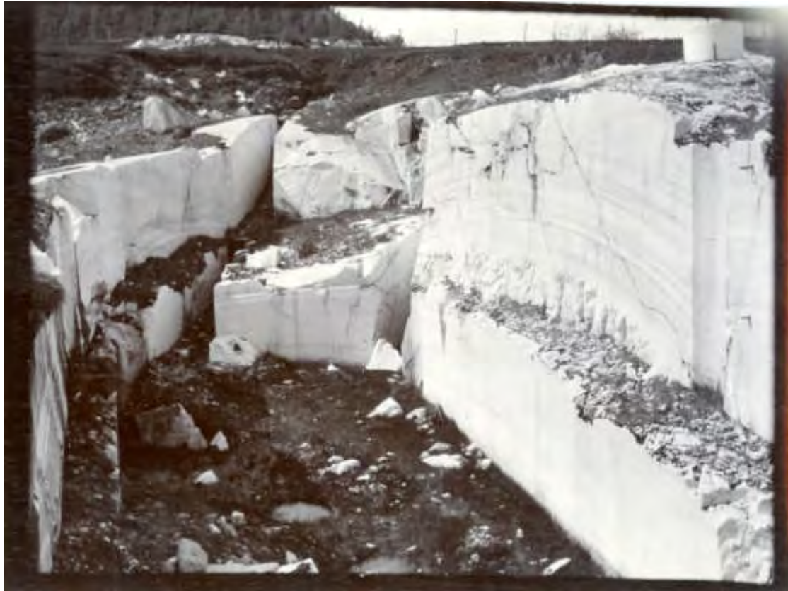
Figur 33. Brudd på lys grå og hvit båndet dolomitt marmor på Hekkelstrand (Foto: Foslie 1913). Den gang brukt som bygningsstein i dag som industrimineral.
