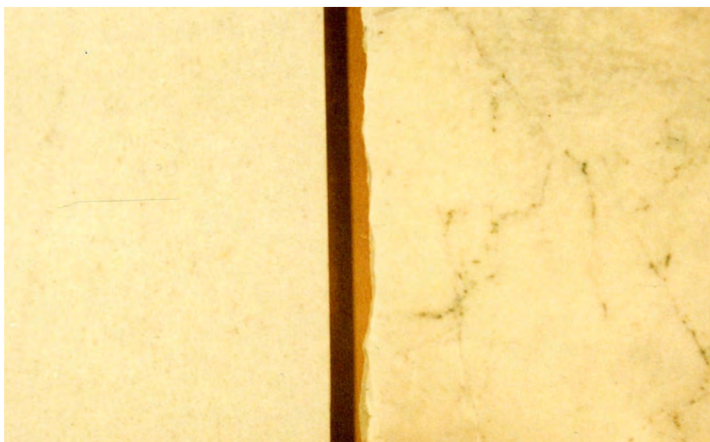
Figur 24. Polerte plater av hvit dolomitt-marmor fra Vikdalen (t.h.) og type Furuli fra Løvgavlen nordvest for Fauske (t.v.). Fotografert i lampelys.
