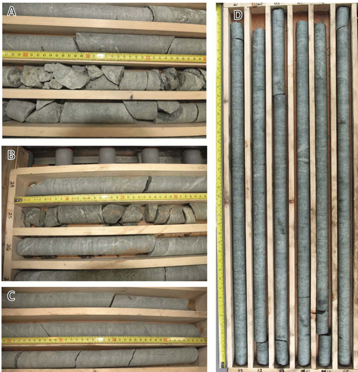
Figur 9 Eksempler på brudd, sprekker og spekkehyppighet. A) Knusningssone karakterisert av oppsprukket til knust bergart over ca. 40 cm intervall som er talk og kalsittrik (BH-1: 9,58-9,93 m) B)Knusningssone i biotittrik del av kjerne. (BH-2: 25,0-25,32 cm) C) Kjerneparti med flere brudd langs kløyplan. D) Oversikt-bilde av hel borekasse med få sprekker. De fleste brudd i denne borekassen er relatert til oppdeling av borkjernen (BH-1:60-66 m).
