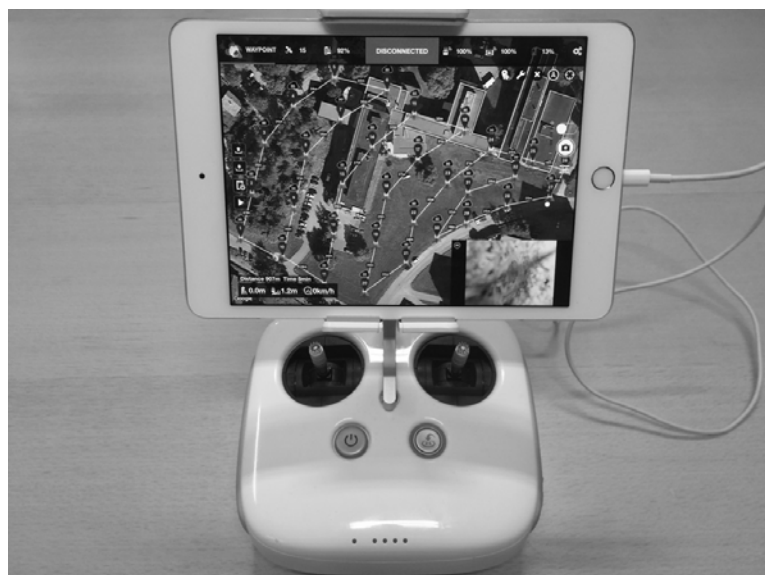
Figur 2: Kontrollenhet til dronen med tilhørende Ipad som brukes til å fjerne styre dronen fra Litchi applikasjonen.
