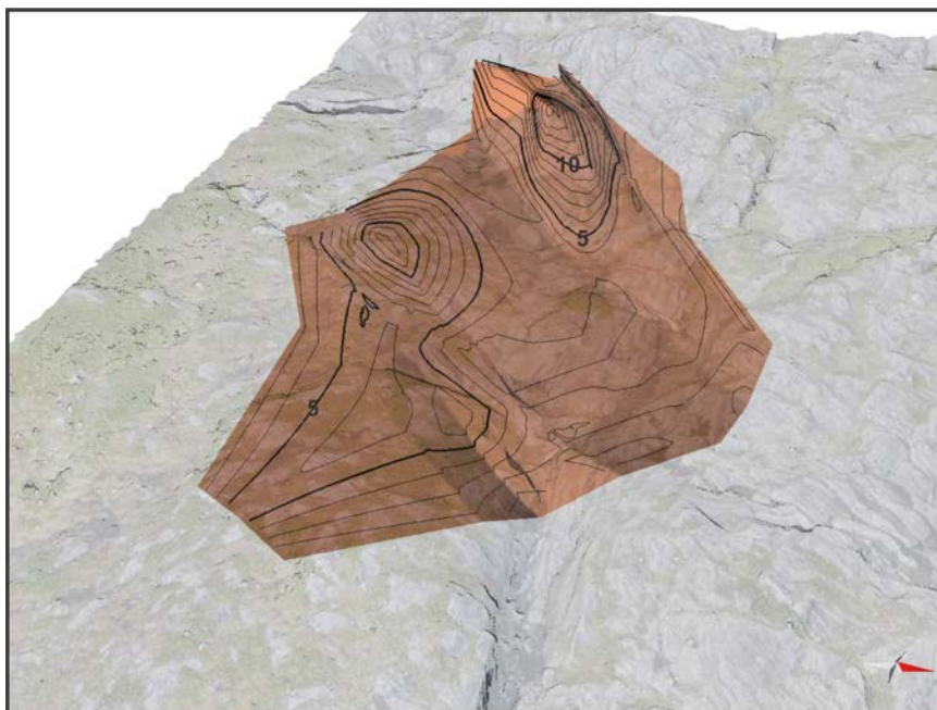
Figur 25: 3D oversikt over den Be >1000 ppm mineraliserte kroppen sett fra NØ (grønn), med tykkelseskoter som viser at kroppen er relativt tynn, og er tykkest i sør, hvor den ligger i nærheten av overflaten.
