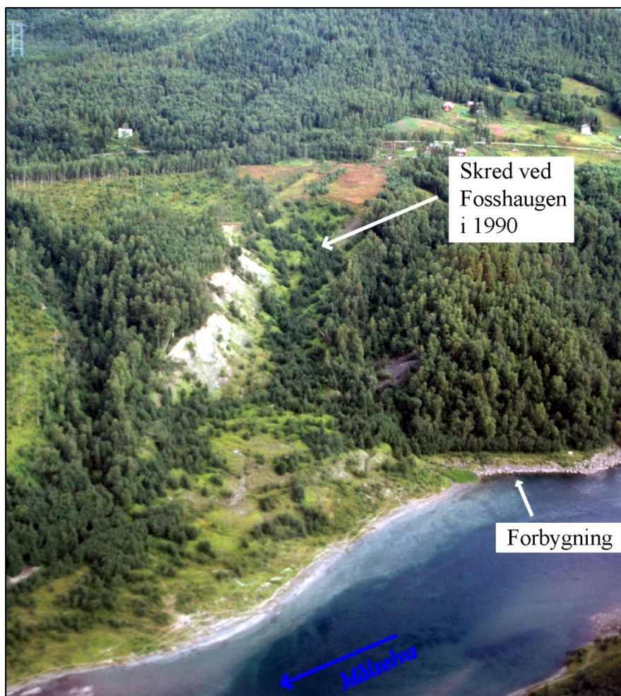
Figur 5. Skredgrop fra hendelse ved Fosshaugen i 1990. Det var foretatt forbygning i yttersvingen til Målselva før skredet gikk. Skredet ble muligens utløst av poreovertrykk i leiravsetningen, siden det ble funnet grunnvannsutslag i skredgropa. Foto: L. Hansen.
