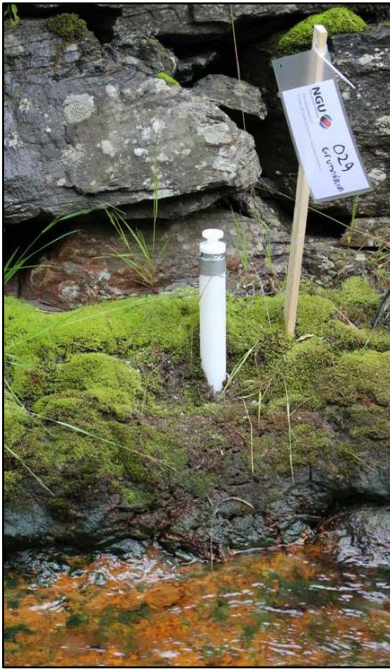
Figur 7: Eksempel på en sandspiss i elvebredden som ble brukt for prøvetaking av grunnvann.
