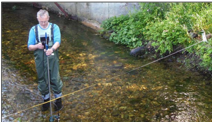
Figur 5: Vannhastighetsmålinger med FlowTracker.
