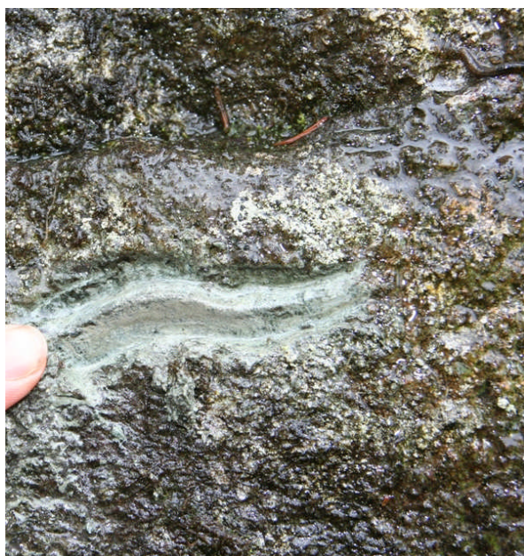
Figur 8. Testhugging av enkel ornamentikk i fastfjellsblotning. Dette er en relativt hard variant og ryggen som står igjen har en del hakk. Bergarten kan karakteriseres mer som metagabbro enn kleberstein. Lokalitet 1191
