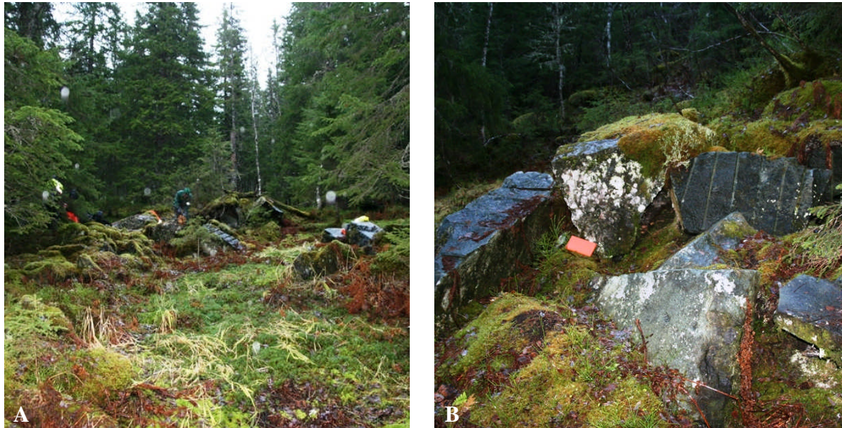
Figur 14. Eksempler på tidligere tiders forsøk på uttak av blokk i Dalhaugen. A. Gammel uttak fra fastfjell med skrottpipp ned til venstre i bildet og enkelte større blokker med mineringshull midt i og til høyre i bildet. Lokalitet 158. B. Blokke med mineringshull og spor fra saging nederst i steinuren. I nær tilknytning til disse blokker er det funnet en jernbjelke og rester av en vedovn. Det er fra disse blokker prøvene beskrevet i Lindahl 2012 og NGUs database over Naturstein er tatt. Lokalitet 142.
