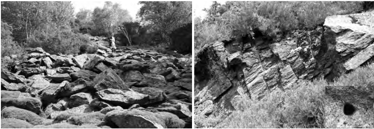
Figur 30. Venstre: storblokket skrotteipp under sprengningsbrudd, Rønsetlia. Høyre: boring på tvers av kløven, Rønsetlia. Innfelt i nederste høyre hjørne: tverrsnitt av typisk trekantet håndboret borhull.
