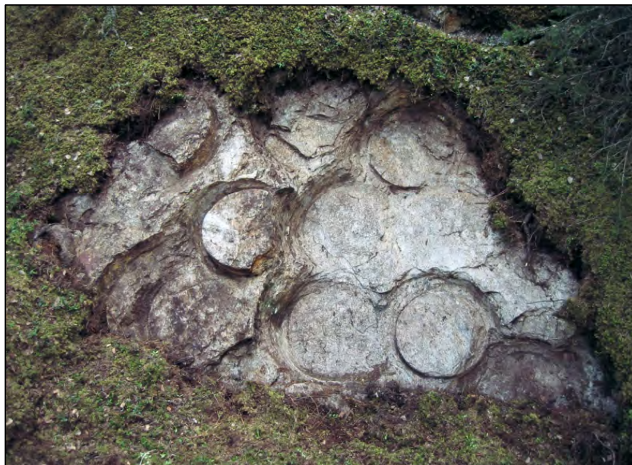
Figur 35. Brudd GBM115 ; bruddflaten sett mot sør. Runde kanaler etter direkte hogging. De fleste emnene herfra var ca. 55 cm.
