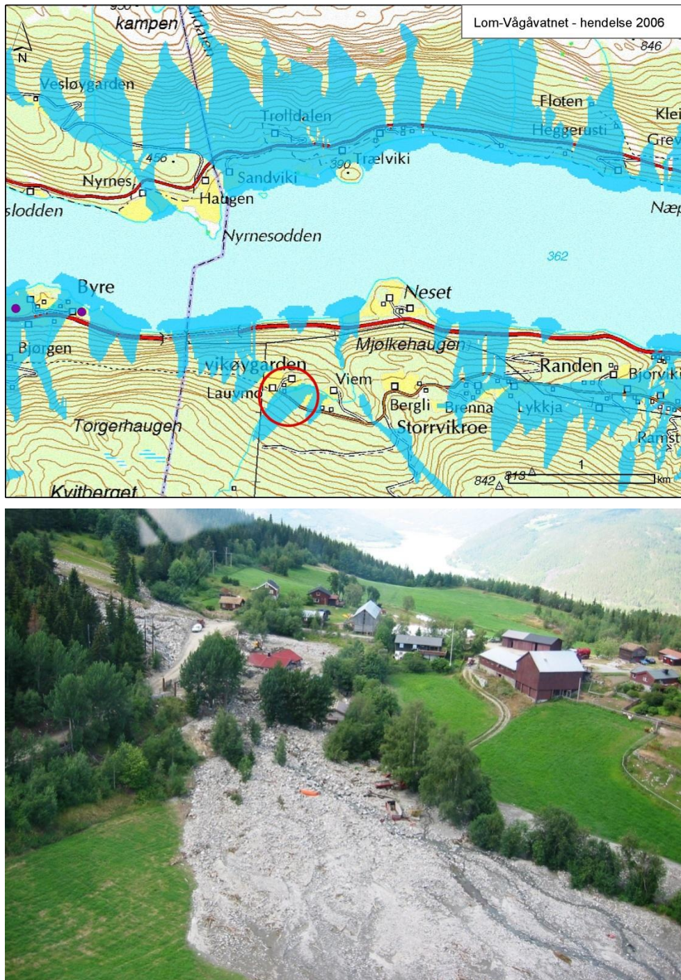
Fig. 28: Flomskredhendelse på sørsiden av Vågåvatnet, Vågå kommune, Oppland, og tilsvarende kartutsnitt av aktsomhetsmodelleringen. Blå: endelig utløpsmodellering, rød markering viser plasseringen av bildet, og de fiolette punktene er registrerte hendelser fra skrednett.no. (Foto: NGI)
