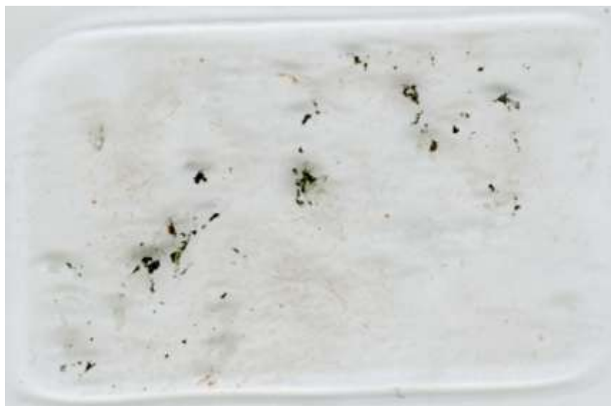
Figur C3. Tynnslip av bergartsprøve fra pukkverk 2. Bergarten er en pegmatittisk granitt.
