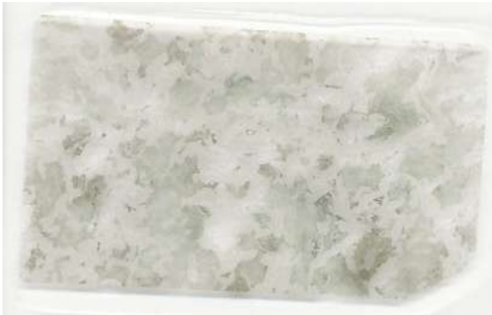
Figur C15. Tynnslip av prøve (3) fra pukkverk 5. Bergarten er en gabbro.
