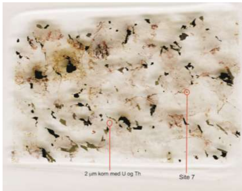
Figur C1. Tynnslip av bergartsprøve fra pukkverk 1. Bergarten er en granitt. Spesielt to korn er av interesse med hensyn til innhold av uran og thorium.
