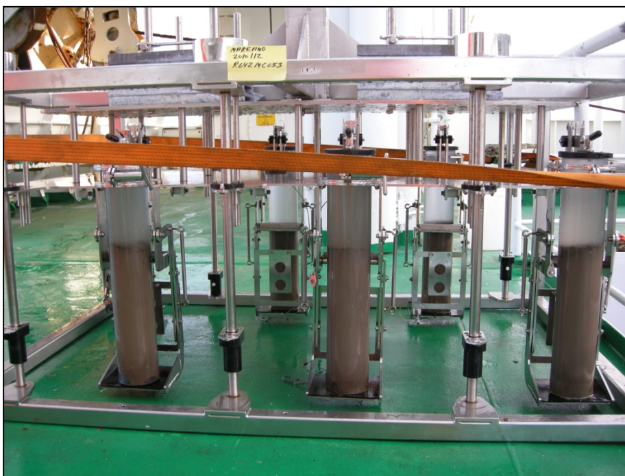
Figur 3. Multicorer med 6 sedimentkjerner på dekk. Prøve fra stasjon R0642 på 2352 m havdyp på kontinentalskråningen i Nordland VI. Lengden på de 6 sedimentkjernene varierer fra 33 cm til 39 cm.
