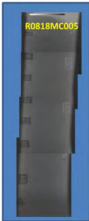
Figur 16. XRI-bilde av sedimentkjerne fra R818, kontinentalskråningen, Nordland VI. Lengden i cm er vist med tallene på venstre side av sedimentkjernen i 5 cm intervaller.
