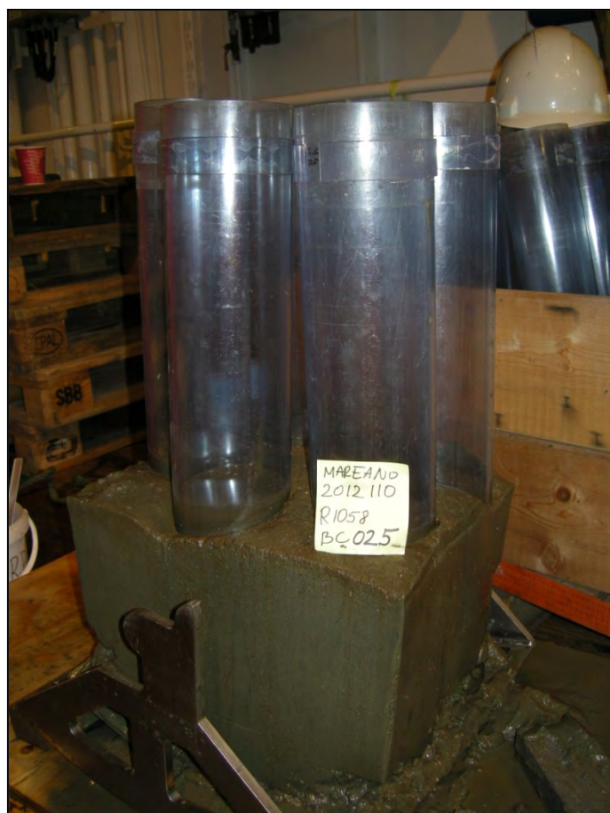
Figur 3. Boxcorer fra stasjon R1058 med 4 PVC rør satt ned i sedimentene.
