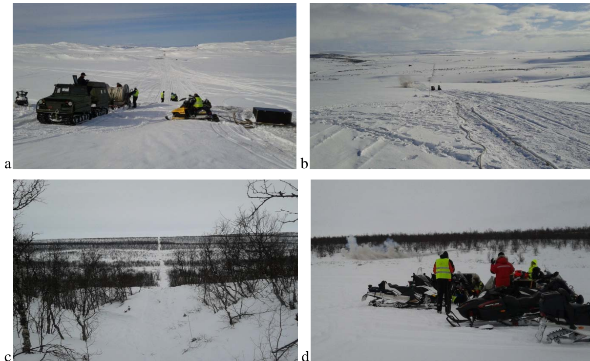
Figur 6. Innsamling av refleksjonsseismiske data på Sennalandet (a og b) og Masi (c og d). Foto b og d viser avfyring av 2x50 m detonerende lunte som brukes som seismisk kilde. Arbeidet ledes av Universitetet i Bergen ved professor Tor Arne Johansen og overingeniør Helge Johnsen med assistanse fra senioringeniør Bent Ole Ruud, overingeniør Espen Lehn-Nilsen og skytterbas Alf Nilsen, UiB, direktør Karstein Røed i Bergen Oilfield Services, landmåler Roar Iversen, Dolphin Geophysical og overingeniør Jomar Gellein og ingeniør Geir Viken fra NGU. Studentene Malin Waage og Marte Strømme og seks innleide feltassistenter fra Masi, Mikkel Per Bongo, Isak Anders Nilsen Eira, Nils Per Nilsen Sara, Eskil Hermansen Hætta, Klemet Anders Bals og Lars Johan Larsen Sara (bandvognkjører) bisto også under datainnsamlingen. Data er prosessert av Bent Ole Ruud, UiB.
