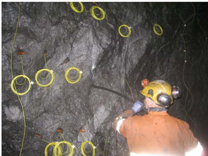
Figur 25. Lading av salve i Trælen grafittgruve på Senja.
