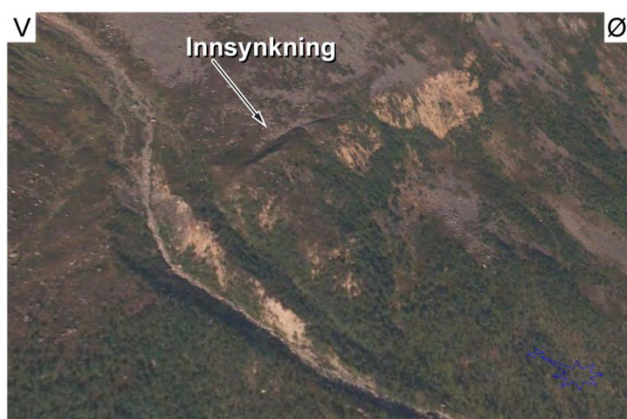
Figur 26: Lineament i Olderdalen som er avmerket i databasen for ustabile fjellpartier basert på flyfototolkning av eldre flyfoto.
