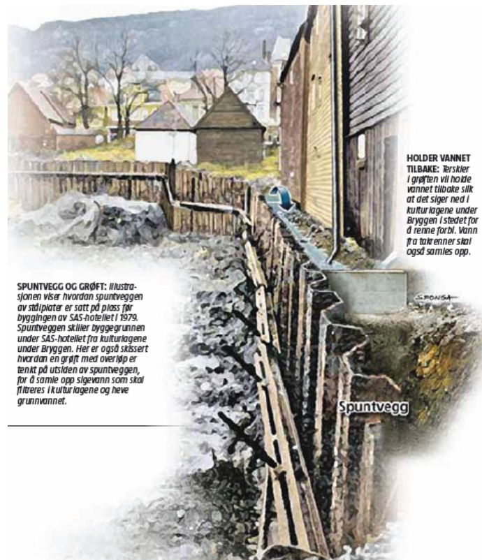
Infiltrasjon langs Bryggen (illustrasjon: T. Sponga, fotogrunnlag Riksantikvaren)
