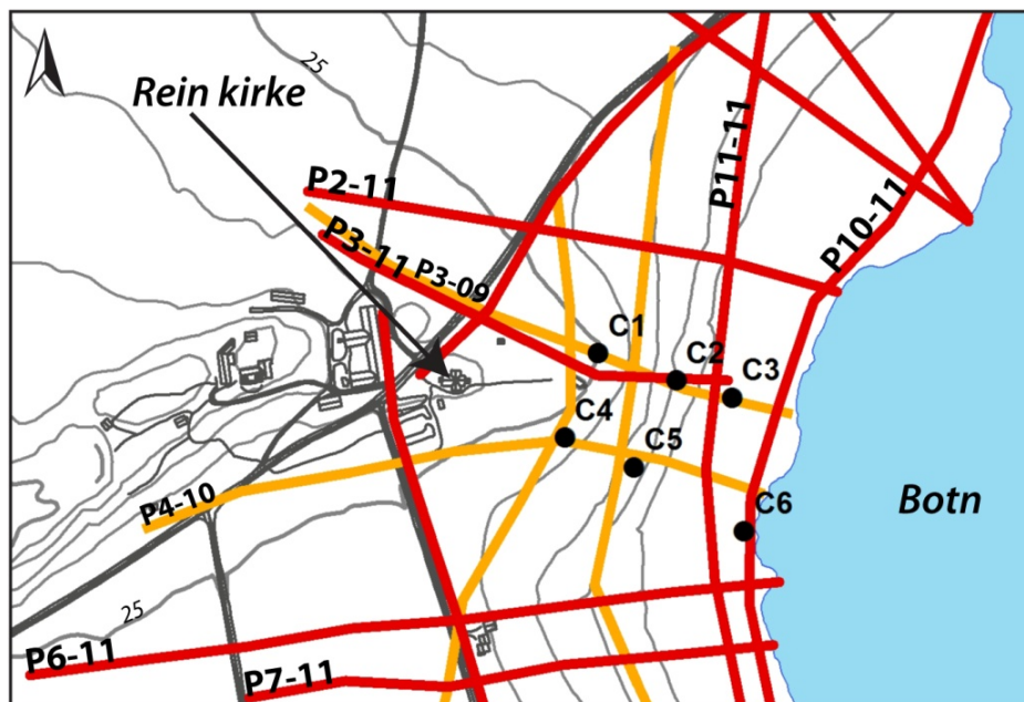
Figur 30. Plassering av sonderingspunkt C1-C6. C2-C6: Dreietrykksondering og CPTU, C1 kun dreietrykksondering (2011-data fra Statens vegvesen).
