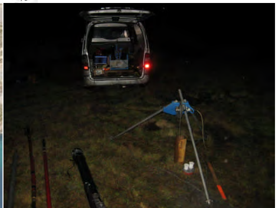
Figur 12. Bh 5, temperatur, ledningsevne i vann, total gammastråling, resistivitet, tilsynelatende porøsitet, seismisk hastighet og sprekkfrekvens.
