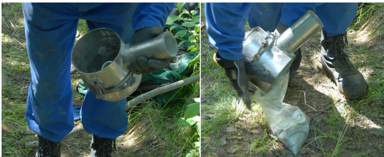
Figur 16. Bilder av prøvebeholderen. Det venstre viser det innvendige av prøvebeholderen med toppen av det innvendige røret synlig. Det høyre viser hvordan borkakset overføres fra beholderen til prøvepose med lynlås når topplokket er fjernet. Klemmelåsene som holder lokket på plass er også vist. Se også Figurene 17 og 18.
