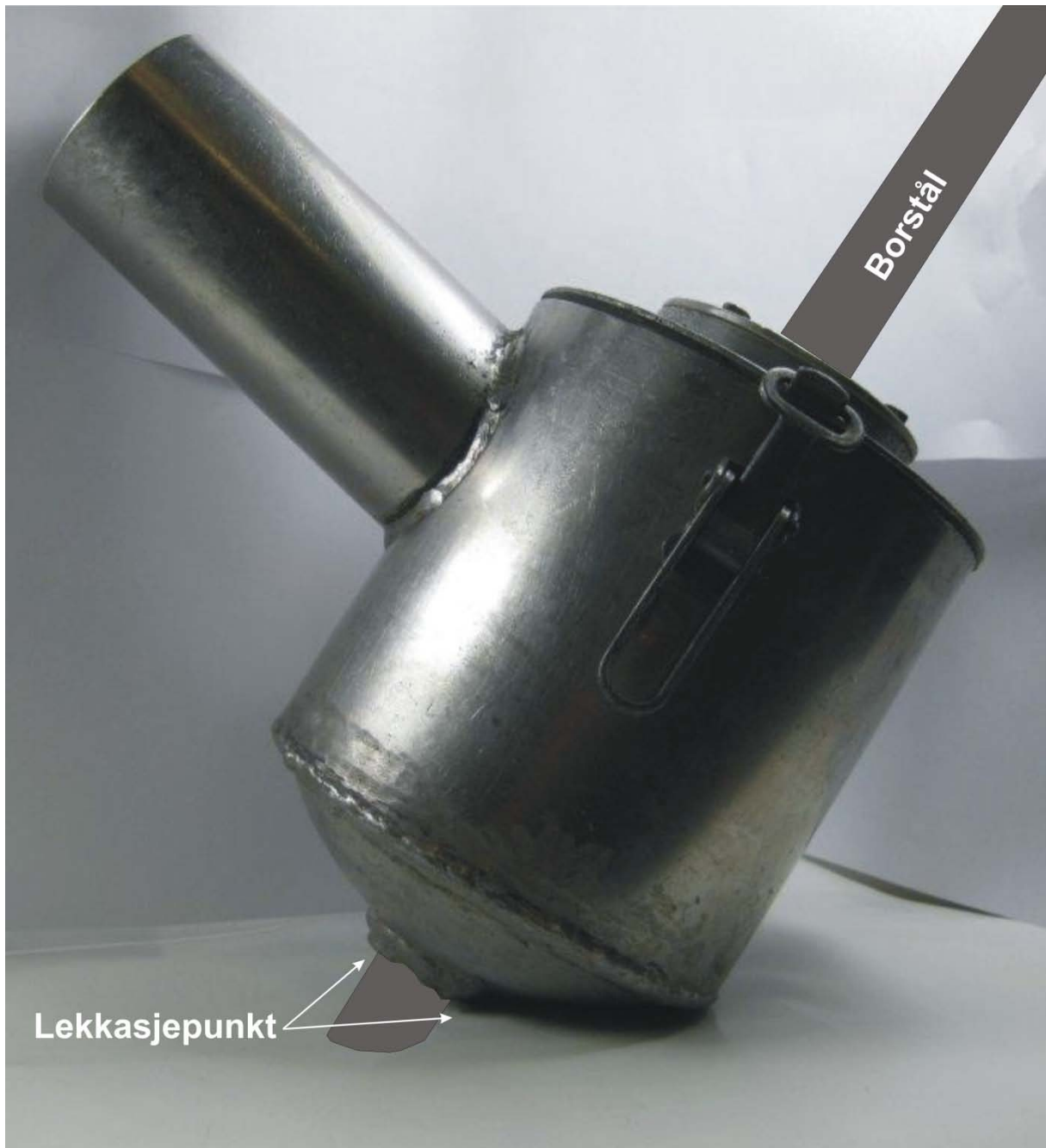
Figur 18. Prøvebeholderens stilling når boret står i vinkel til fjelloverflaten. Det er da gode muligheter for lekkasje av borkaks ved overgangen mellom fjell og prøvebeholder (lekkasjepunkt).
