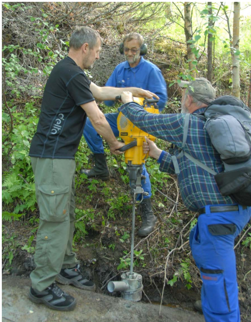
Figur 15. Pionjär slagbormaskin med prøvebeholder som hviler på fjellet. Fra venstre grunneier Yngve Fløttkjær, overingeniør Leif Furuhaug og forsker Peter M. Ihlen som prøver å få start på en kald maskin.
