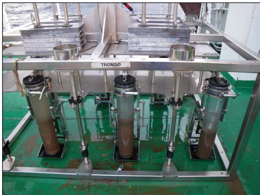
Figur 3. Multicorer med sedimentkjerner på dekk. Prøvetaking på stasjon R488 på 2220 m havdyp i Nordland VII.
