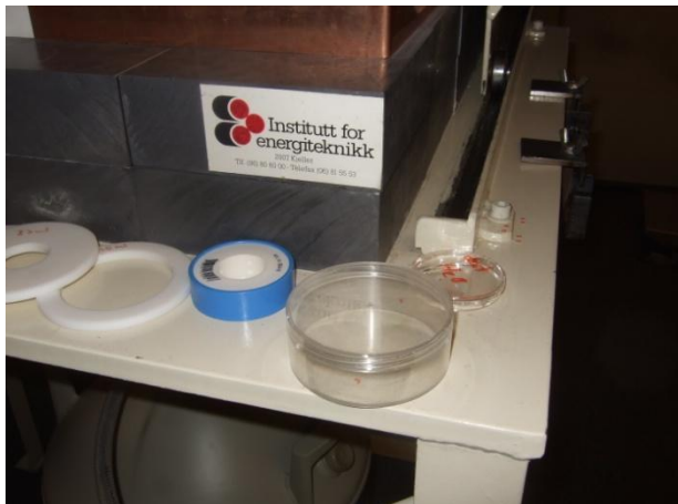
Prøveeske til 300gram og Germaniumdetektor til høyere
