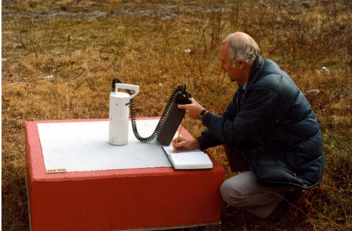
Figur 3. (fra Walker 1993) Kalibrering av instrument for måling av gammastråling i bakken. Ved å måle på 4 syntetiske prøver ("pads") med kjent innhold av uran, thorium og kalium, kan instrumentene kalibreres slik at konsentrasjoner av de radioaktive elementene i bakken kan beregnes (Grasty et al. 1991).
