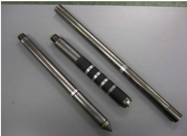
Figur 10: RCPT-sonde. Fra venstre: CPT-spiss, resistivitetssonde (4 elektroder: 3,5 cm elektrodeavstand), batteripakke (Aasland 2010).
