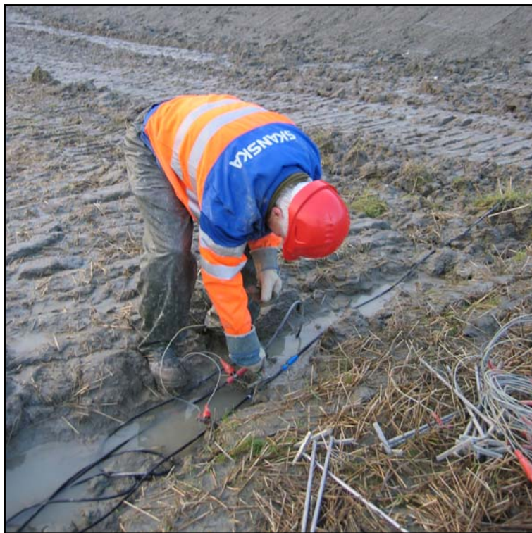
Figur 3: Elektroder knyttet til kabler for resistivitetsmålinger settes ned i leira. Man bruker 1-4 stålelektroder i hvert målepunkt avhengig av hvor god kontakt man får med grunnen (Foto: IL Solberg).
