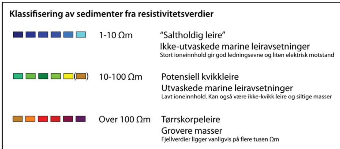
Figur 4: Fargeskala som brukes i NGU-prosjekter knyttet til kartlegging av potensiell kvikkleire (Solberg et al. 2011).
