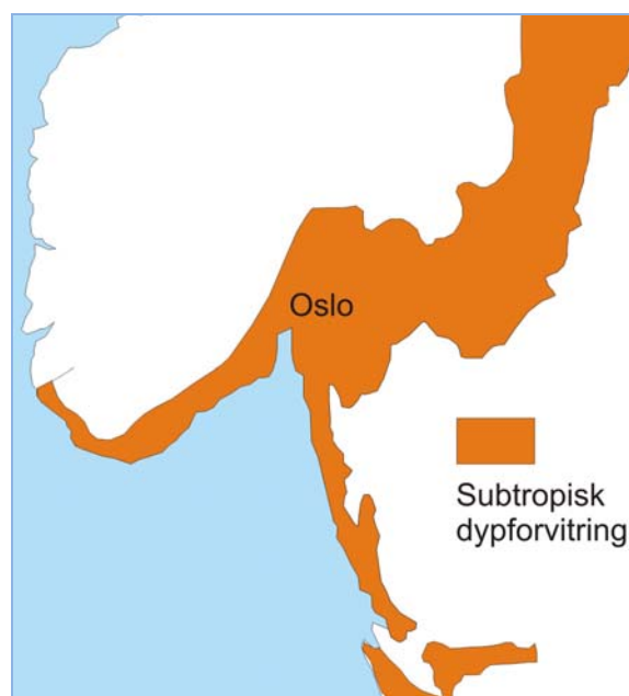
Figur 1. Områder med rester av subtropisk dypforvitring i sprekkesoner og mye leirholdig berggrunn i Sør-Norge og Sør-Sverige. Dette gir dårlige forhold for tunnelbygging. En stor del av vei- og jernbanetunnelene på Østlandet og Sørlandet bygges nå innenfor dette problemområdet. Kartet er modifisert fra Lidmar-Bergström o.a. (1999)
