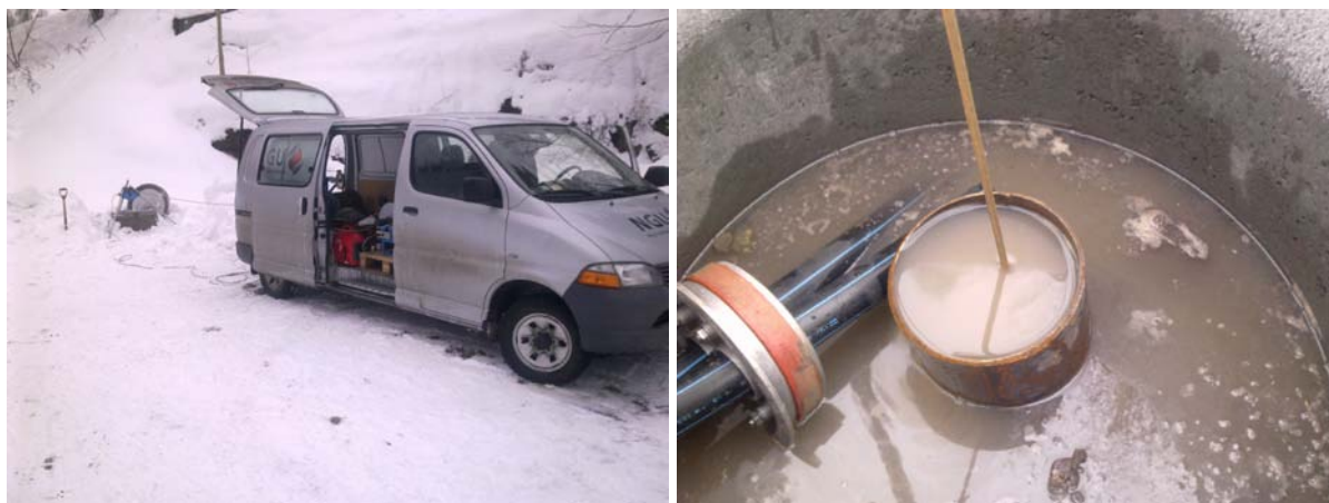
Figur 24. Logging i FB 85,5. Grumset vann (høyre) hindret måling med OPTV.
