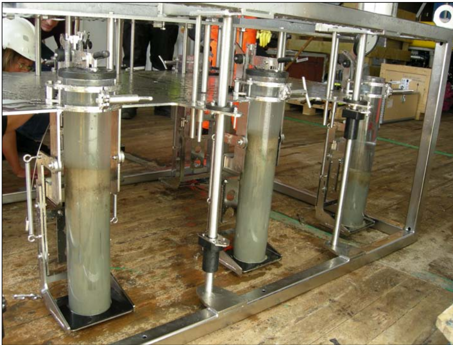
Figur 4. Multicorer prøverør med sedimentkjerne på dekket av F/F G.O. Sars. Seks gjennomsiktige pleksiglassrør med indre diameter 106 millimeter benyttes. Bildet viser tre sedimentkjerne fra stasjon R209 (skråningen). Lengden på rørene er 60 cm. Lengdene av sedimentkjernene er 37- 40 cm.
