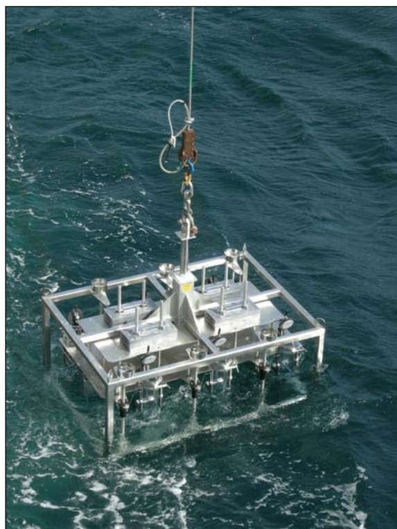
Figur 3. Multicoreren på vei ut fra skipssiden på F/F G.O. Sars, klar for prøvetaking. Bildet er fra toktet i juni 2008.
