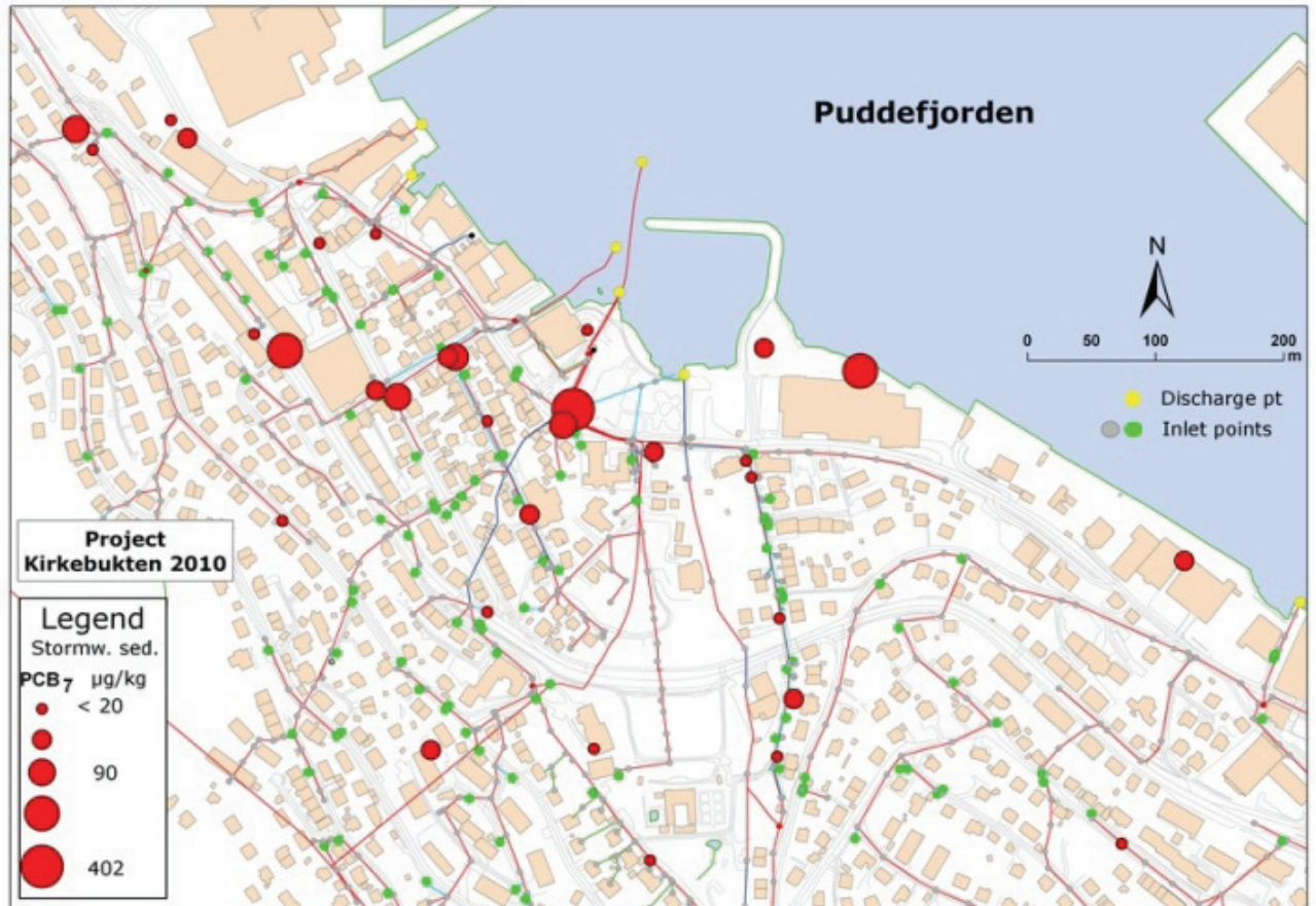
Figur 2: Avløpsledninger som leder til Kirkebukten, med sandfangsprøver og PCB 7 -konsentrasjoner.
