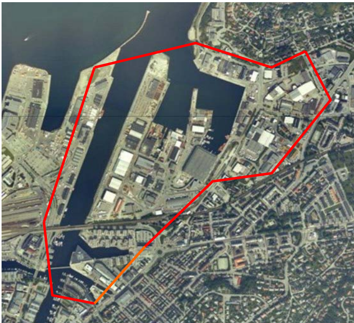
Figur 1 Område som er undersøkt med hensyn på aktive forurensningskilder. Nesten hele arealet er dekket av tette flater (asfalt og bygninger)
