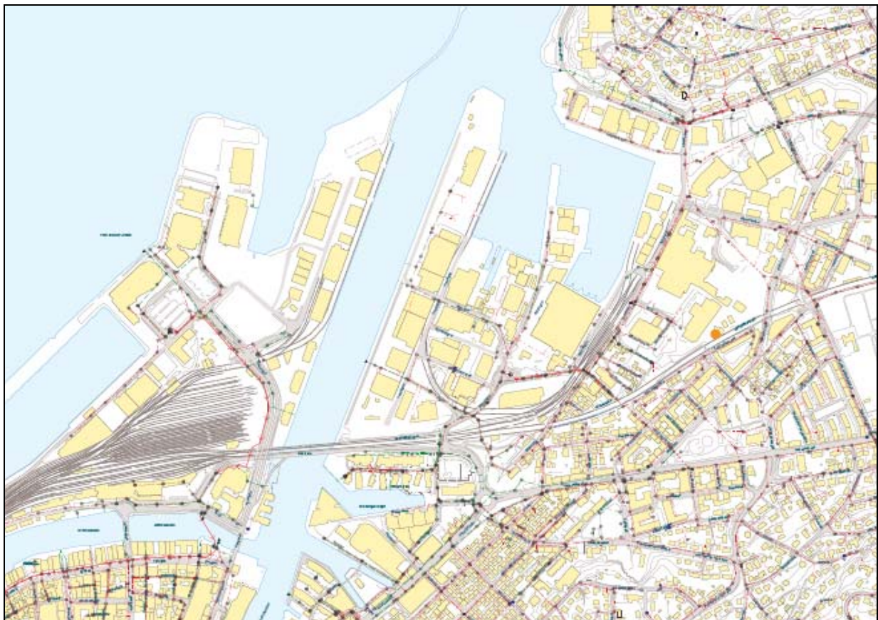
Figur 5 Ledningskart for det kommunale avløps- og overvannssystemet.
