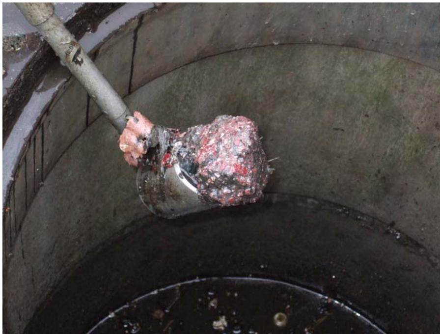
Figur 10 Innsamling av sedimentprøve fra sandfangskum. Prøven er full av malingsflak fra den nærmeste husfasaden.
