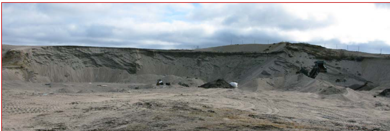
Figur 10: Massetaket i Karlebotnmoen, sett mot sør. Snittet viser sandige skrålag med fall mot nord. Øverst ser man planum for uttak av et 2-3 m grovt topplag.
