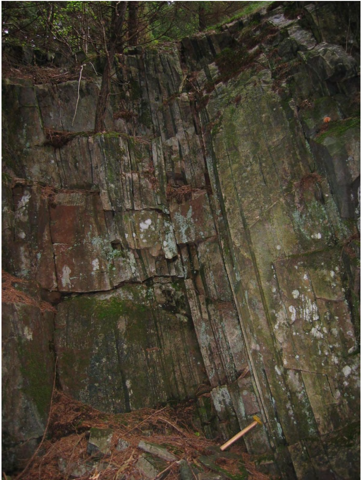
Figur 27: Parti fra forekomsten langs skogsbilveien 300 meter N for gården Auåa av grå granittisk gneis med tynne, mørke bånd av amfibolitt med velutviklet planfoliasjon.
